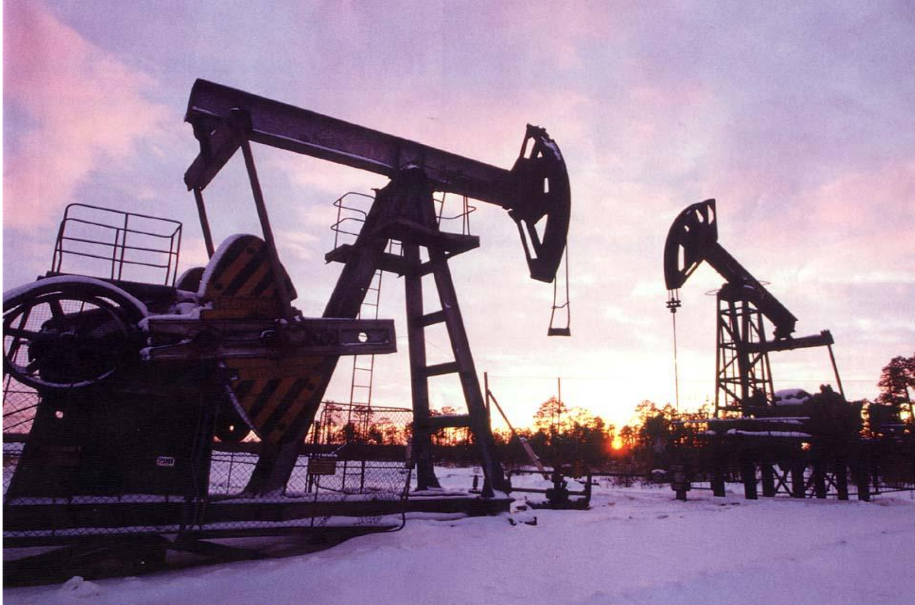
Добыча нефти с помощью штангового глубинного насоса (станок-качалка)
