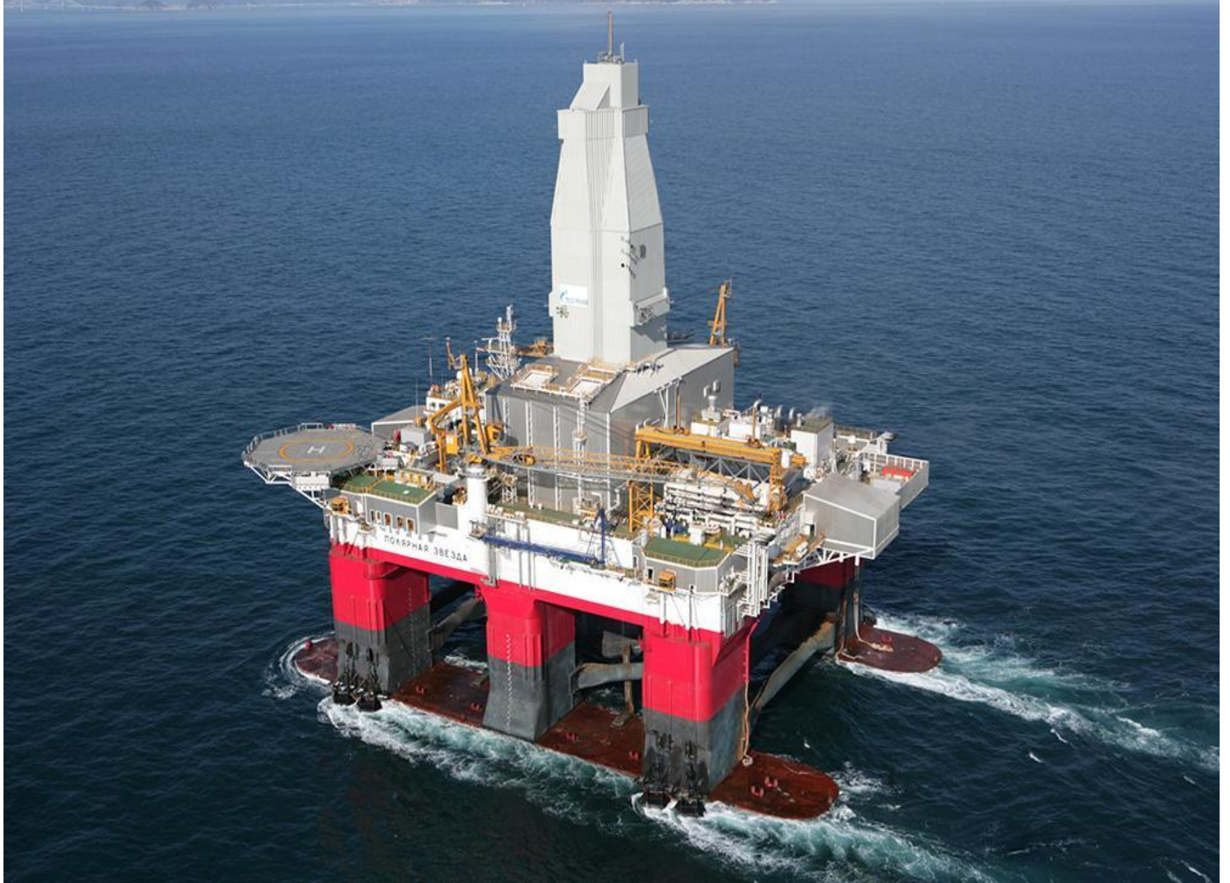
Плавучая полупогружная буровая установка «Полярная звезда» /pro-arktiki.ru/
