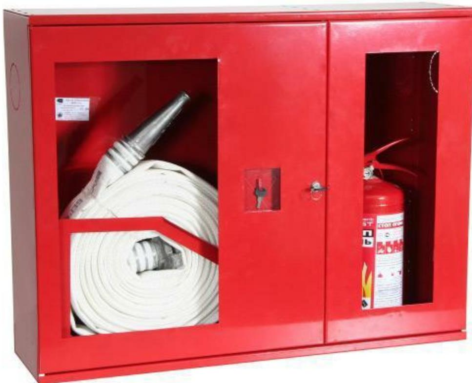
Пожарные краны административно-офисного здания размещаются из расчета орошения каждой точки одной пожарной струей воды производительностью не менее 2,5 л/с
