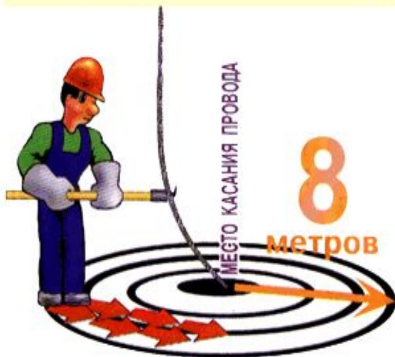
В РАДИУСЕ **8 МЕТРОВ** ОТ МЕСТА КАСАНИЯ ЗЕМЛИ ЭЛЕКТРИЧЕСКИМ ПРОВОДОМ МОЖНО ПОПАСТЬ ПОД **«ШАГОВОЕ» НАПРЯЖЕНИЕ.**
