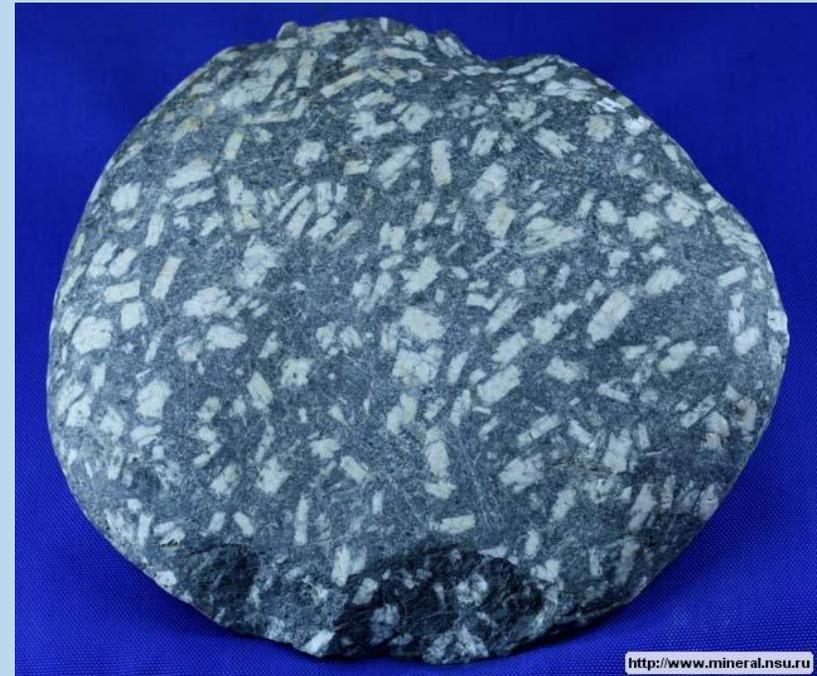
**4. Габбровая структура** - характерна для основных пород, состоящей из плагиоклаза и темноцветов, все минералы образуют довольно изометричные зерна с примерно одинаковой степенью идиоморфизма, хотя иногда отмечается более выраженный идиоморфизм темноцветных минералов по отношению к плагиоклазу.
