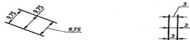
Рис. 44. Нанесение размерных чисел при недостатке места
