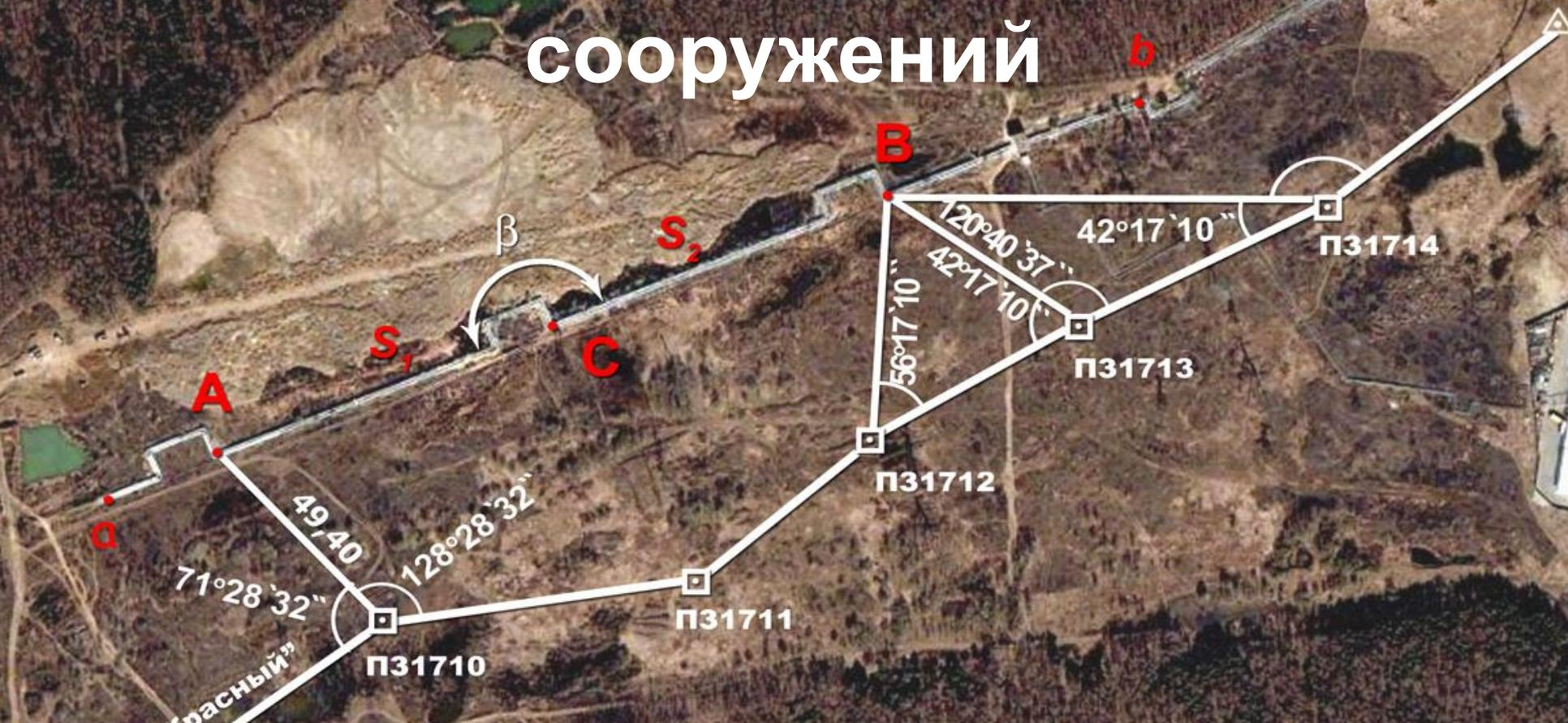
*Линейными* называют такие сооружения, которые имеют большую протяженность при сравнительно малой ширине. К таким сооружениям относят железные и автомобильные дороги, линии электропередач, связи, водопровода, канализации, теплотрассы, газопроводы и другие виды трубопроводов.
