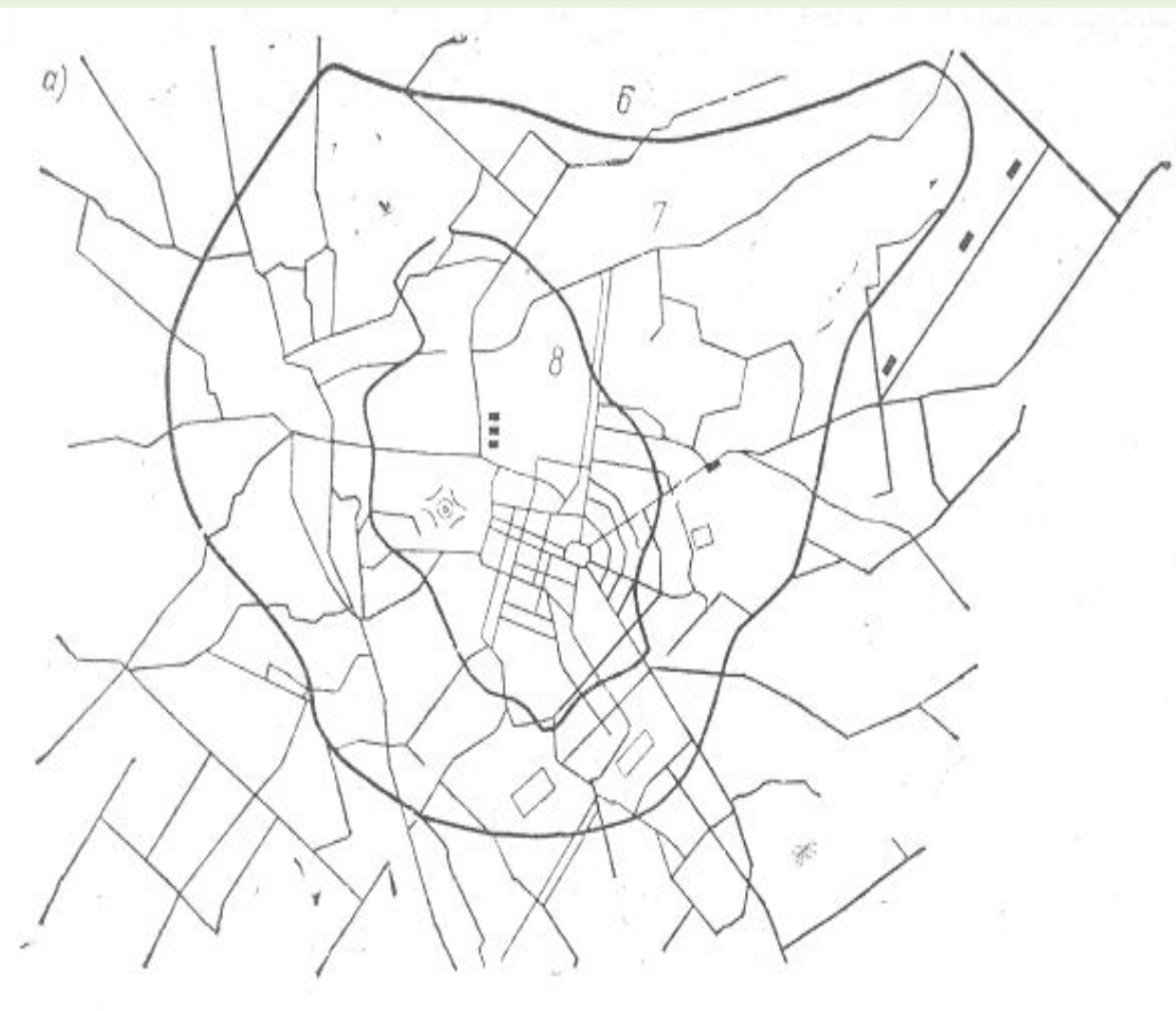
7.2- rasm. Toshkent zilzilasi izoseystasi (a) va seysmogrammalari (b): 1 – 26.IV.66 yil, 2 - 28.IV.66 yil, 3 - 10.V. 66 yil.
