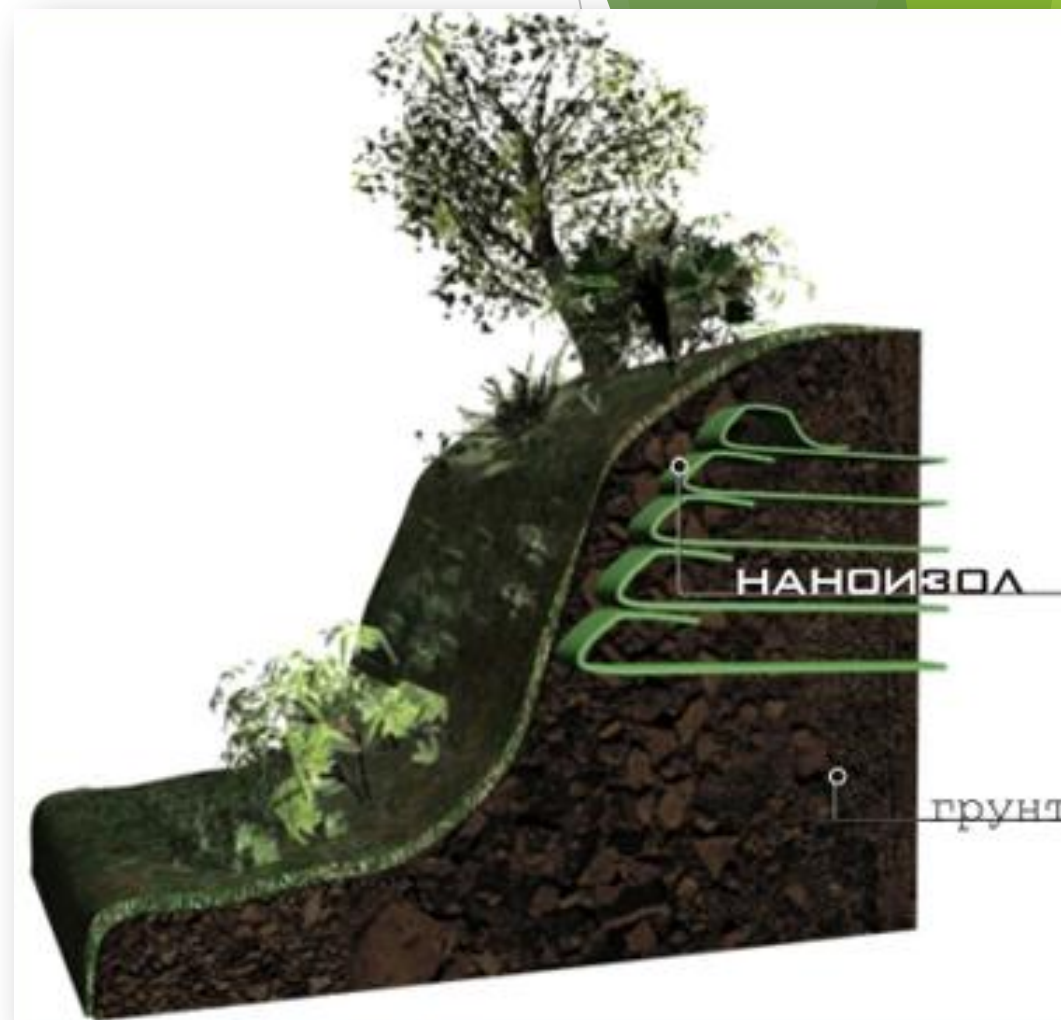
Схема устройства подпорной стенки из грунта армированного геотекстилем (наноизол geo).
