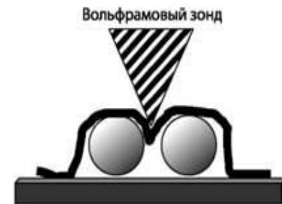
Рис. 4.3. Однослойная углеродная нанотрубка может существенно увеличить точность АСМ
