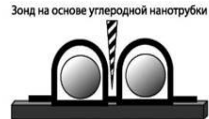
Рис. 4.4. В атомно-силовой микроскопии более острая игла-зонд позволяет повысить точность измерений
