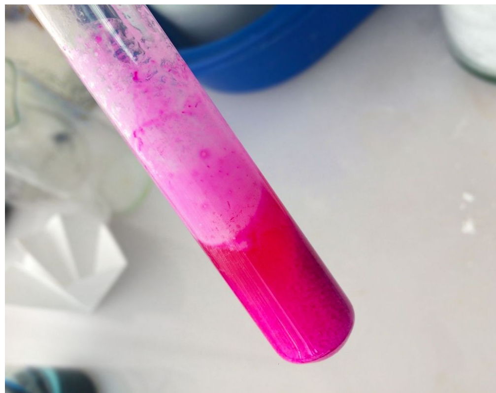
Рисунок 9. Качественная реакция с использованием фенолфталеина
