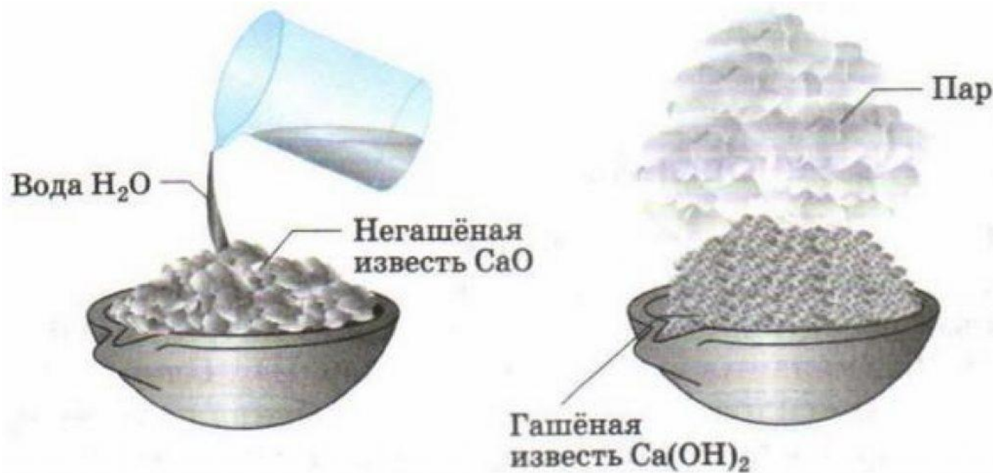
Рисунок 3. Процесс гашения извести
