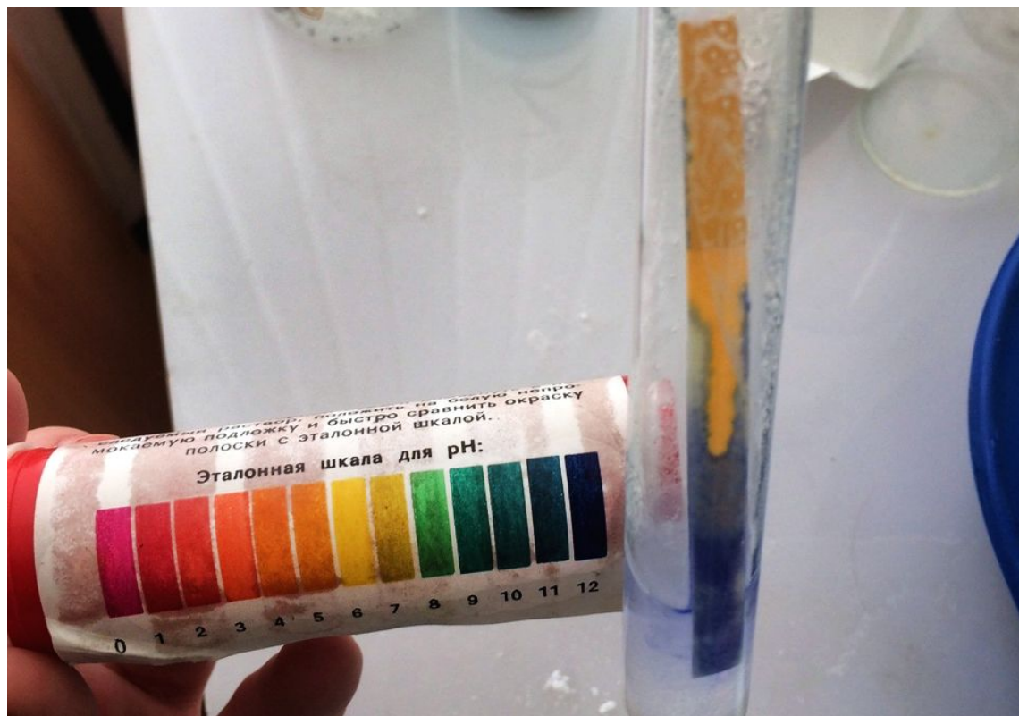
Рисунок 8. Качественная реакция с использованием универсального индикатора
