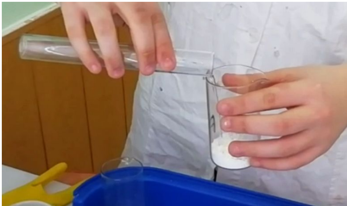
Рисунок 7. Добавление воды к оксиду кальция
