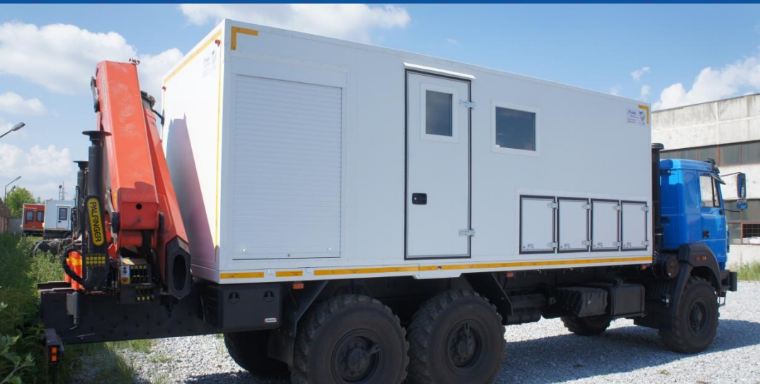
Агрегат ремонтно-сварочный (АРС-4) на шасси Урал 4320 с крано-манипуляторной установкой PALFINGER 30002K
