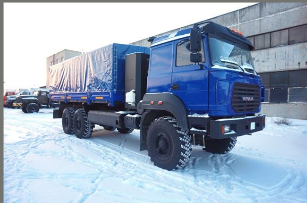
Бортовой автомобиль на метановом шасси Урал 4320, оборудован тентом
