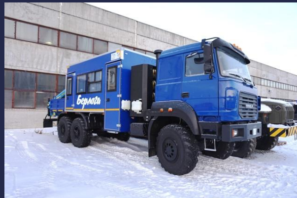
Вахтовый автобус «Берлога» на метановом шасси Урал 4320, 12 мест с КМУ ИМ-55
