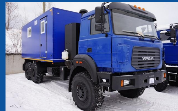
Транспортно-бытовая машина ТБМ на метановом шасси Урал 4320
