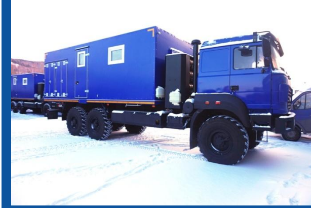
Агрегат ремонтно-сварочный АРС-4 на метановом шасси Урал 4320
