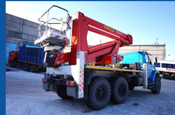
Автогидроподъемник АГП Palfinger 280А на шасси Урал Next
