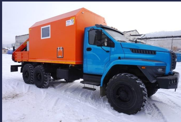
Агрегат ремонта станков-качалок АРОК на шасси Урал Next с КМУ Palfinger PK 10000
