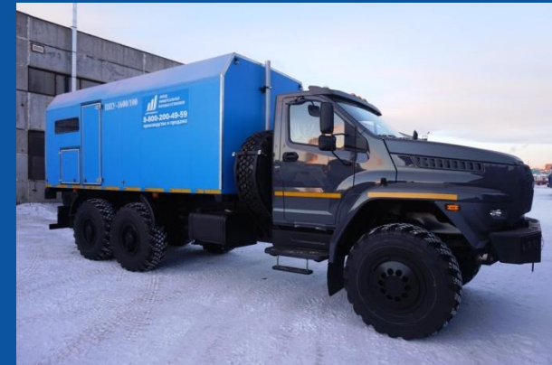
Передвижная паровая установка ППУА 1600/100 на шасси Урал Next
