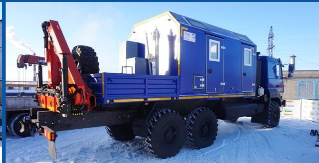
Агрегат ремонта станков-качалок АРОК на метановом шасси Урал 4320 с КМУ РК 8500
