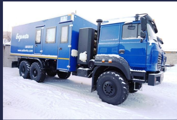
Вахтовый автобус «Берлога» на метановом шасси Урал 4320, 8 мест с грузовым отсеком
