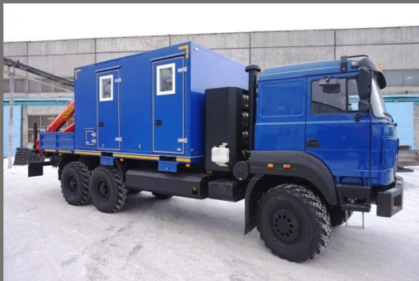
Агрегат ремонта станков-качалок АРОК на метановом шасси Урал 4320 с КМУ РК 8500
