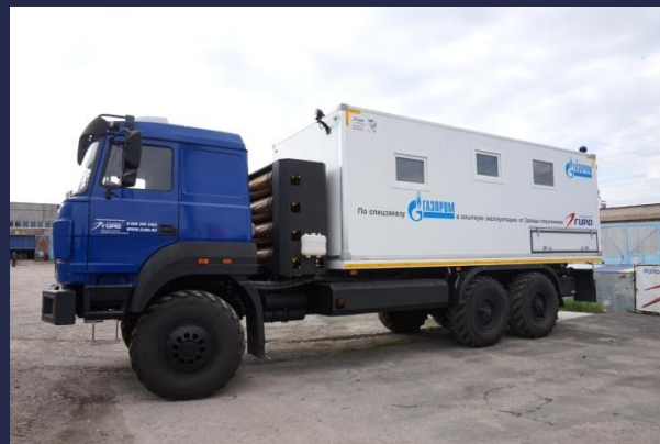
Лаборатория исследования скважин ЛИС на метановом шасси Урал
