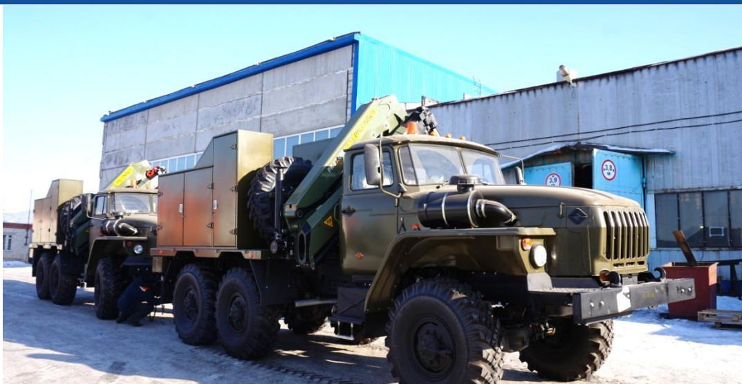
Машина технической помощи МТП на шасси Урал 432007
