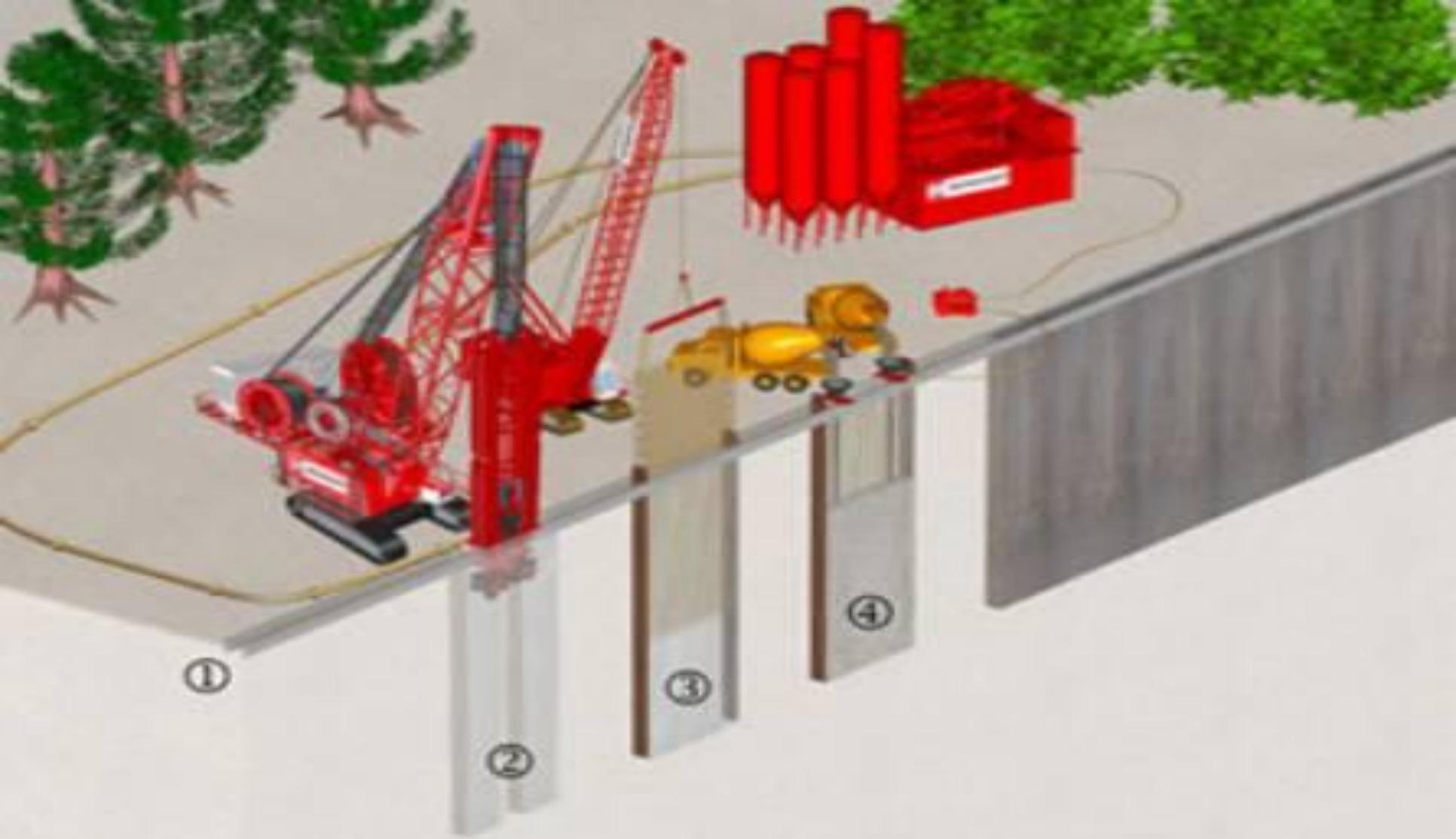
**1 - устройство форшахты (укрепление верха траншеи); 2 - рытье траншеи на длину захватки; 3 - монтаж арматурных каркасов; 4 - бетонирование на захватке методом вертикально перемещаемой трубы**
