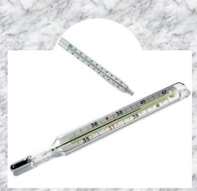
Действие термометров основано на различии коэффициентов теплового расширения термометрического вещества и оболочки, в которой она находится
