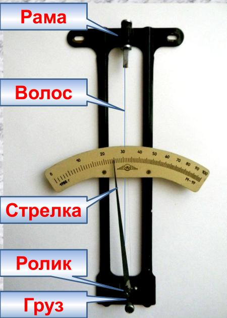
Принцип действия волосного гигрометра основан на свойстве обезжиренного волоса (человека или животного) изменять свою длину в зависимости от влажности воздуха, в котором он
