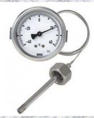
Действие манометрических термометров основано на использовании зависимости давления вещества при постоянном объеме от температуры.
