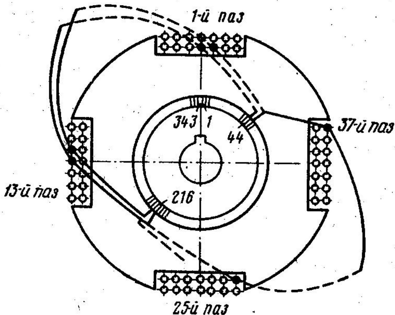
Рис. 45. Схема соединения обмотки якоря электродвигателя НБ-431П
