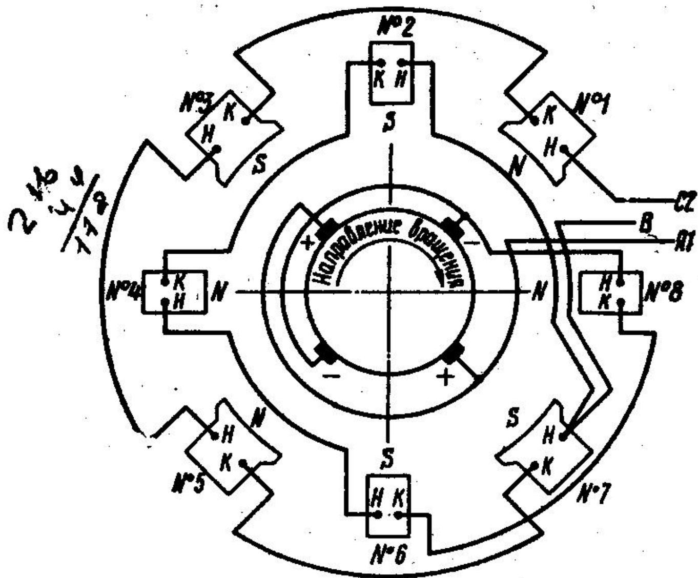
Рис. 44. Схема соединения катушек полюсов электродвигателя НБ-431П
