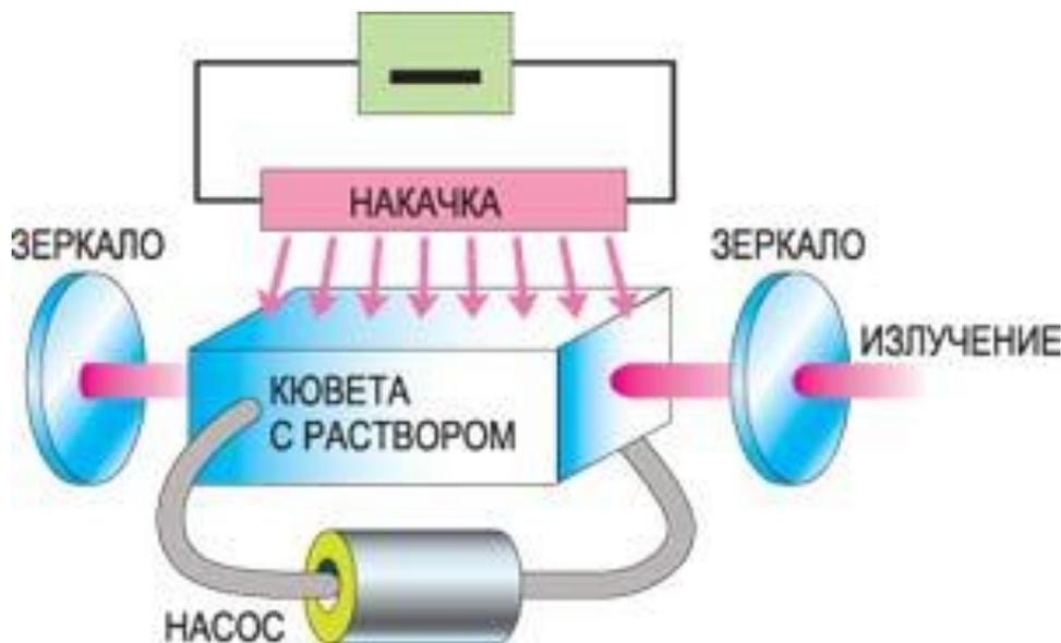
Для жидкостных лазеров применяют непрерывную или импульсную оптическую накачку от вспомогательного лазера или от газоразрядной лампы.
