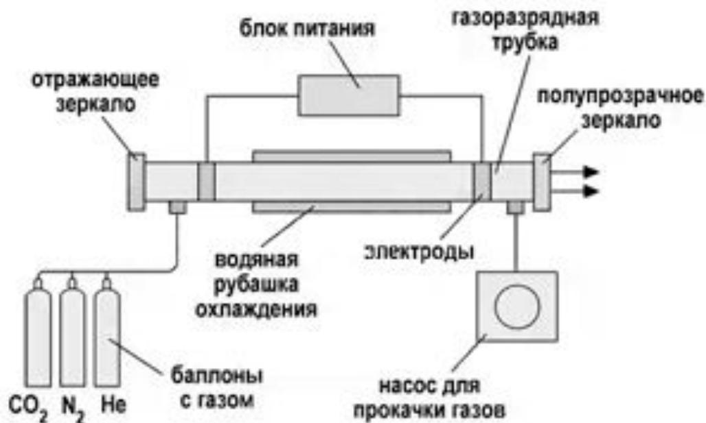
Разнообразие газовых лазеров основано на явлении усиления света. Активная среда таких лазеров представляет собой либо отдельные атомы или молекулы, либо смесь различных веществ в зависимости от функциональности системы.
