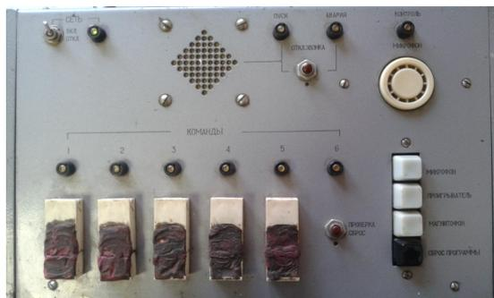
Пульт управления передачей сигналов оповещения П-164-У – для передачи управляющих сигналов на включение электросирен системы оповещения населения; голосовых сообщений на РТУ и СЦВ, проверочных команд
