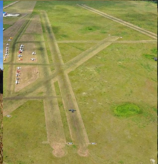
Грунтовые взлетно-посадочные полосы (ГВП) представляют собой специально подготовленную из местного грунта площадь, предназначенную для совершения безопасных взлетов и посадок самолетов.
