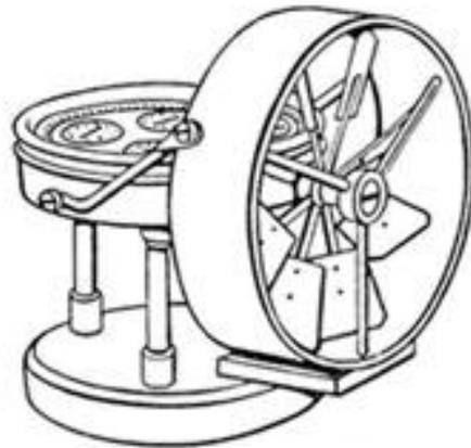
Рис. 2 Анемометр с мельничной вертушкой
