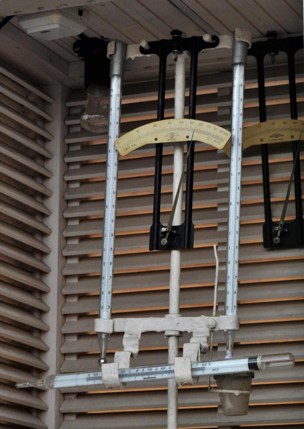
**Максимальный и минимальный термометры** служат для измерения самой высокой и самой низкой температурой соответственно за время между срочными наблюдениями.
