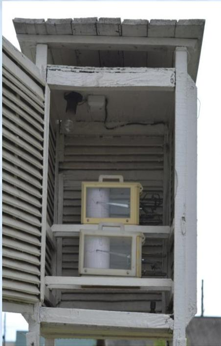
**Гигрограф** - прибор для непрерывной регистрации относительной влажности воздуха. Чувствительным элементом гигрографа служит пучок обезжиренных человеческих волос, которые хорошо реагируют на влажность воздуха.
