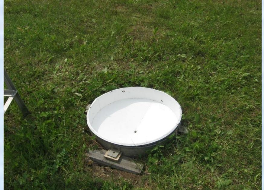
Прибор для сбора и измерения количества выпавших атмосферных осадков. Представляет собой цилиндрическое ведро строго определенного сечения. Количество осадков определяется путем сливания попавших в ведро осадков в специальный дождемерный стакан, площадь сечения которого также известна. Твердые осадки (снег, крупа, град) предварительно растапливаются. Конструкция осадкомера предусматривает защиту от быстрого испарения осадков и от выдувания попавшего в ведро осадкомера снега.
