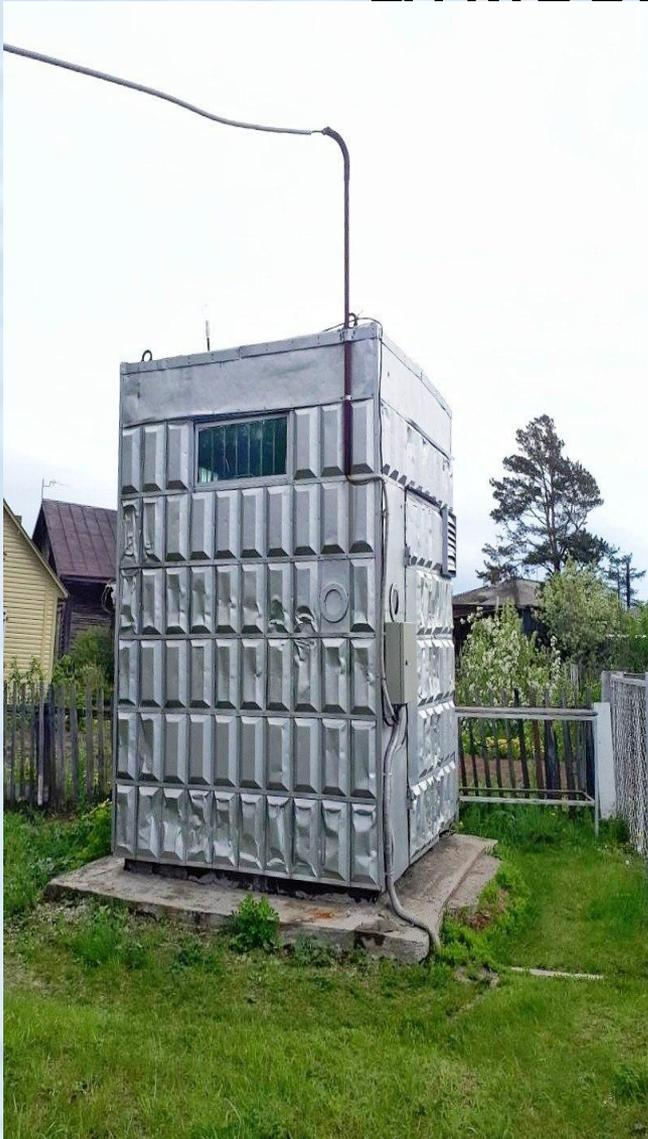
Стационарный пост используется для постоянного наблюдения за концентрацией загрязняющих веществ в воздухе или для постоянного отбора проб воздуха с их последующим анализом в специальной лаборатории.
