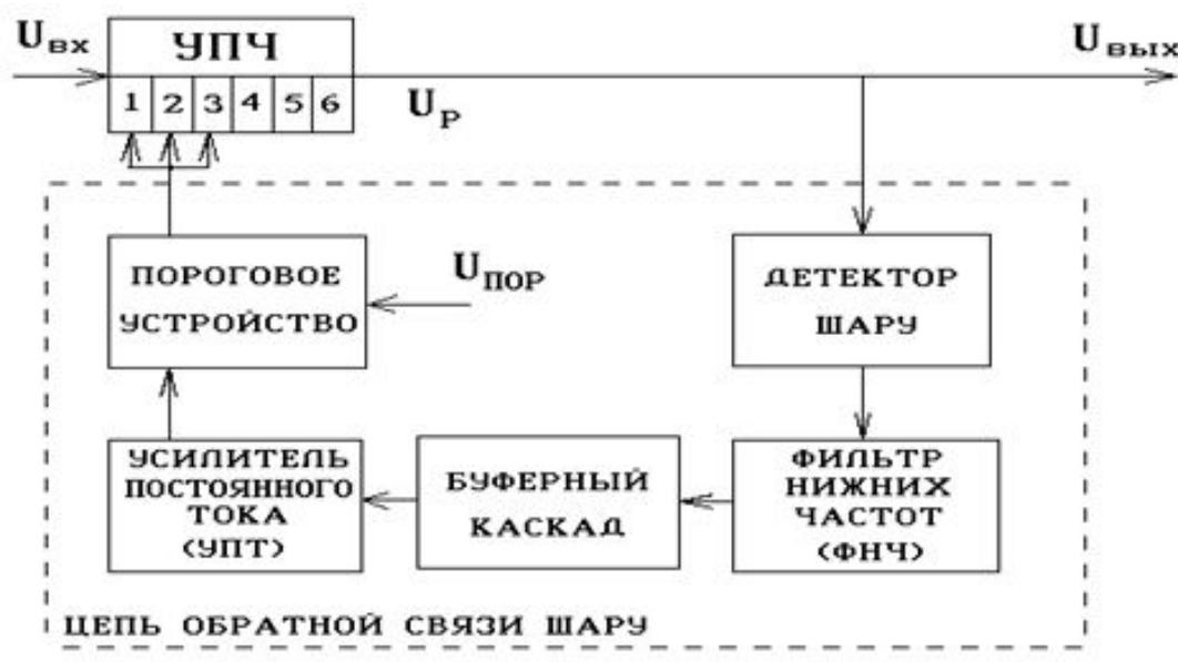
Структурная схема ШАРУ непрерывного действия представлена на рис. Она состоит из регулируемого усилителя и цепи обратной связи (цепи ШАРУ). Схема ШАРУ непрерывного действия применяется в условиях воздействия на РЛС АШП с резко выраженной нестационарностью.
