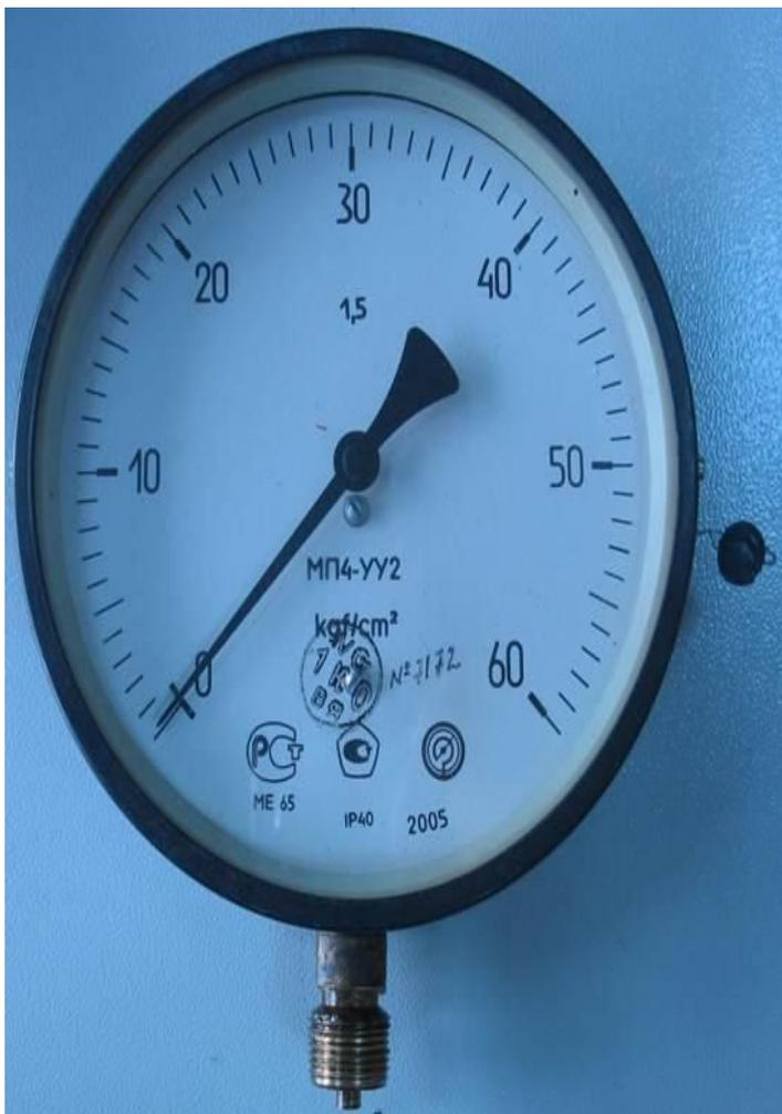
К использованию допускаются манометры прошедшие поверку. На манометр прошедший поверку наносят клеймо (на стекло или тыльную сторону корпуса), доступ к внутренним узлам прибора ограничивают путем установки пломбы или оттиска на мастике на винт фиксирующий корпус манометра (вместо поверительного клейма может наноситься наклейка поверителя).
