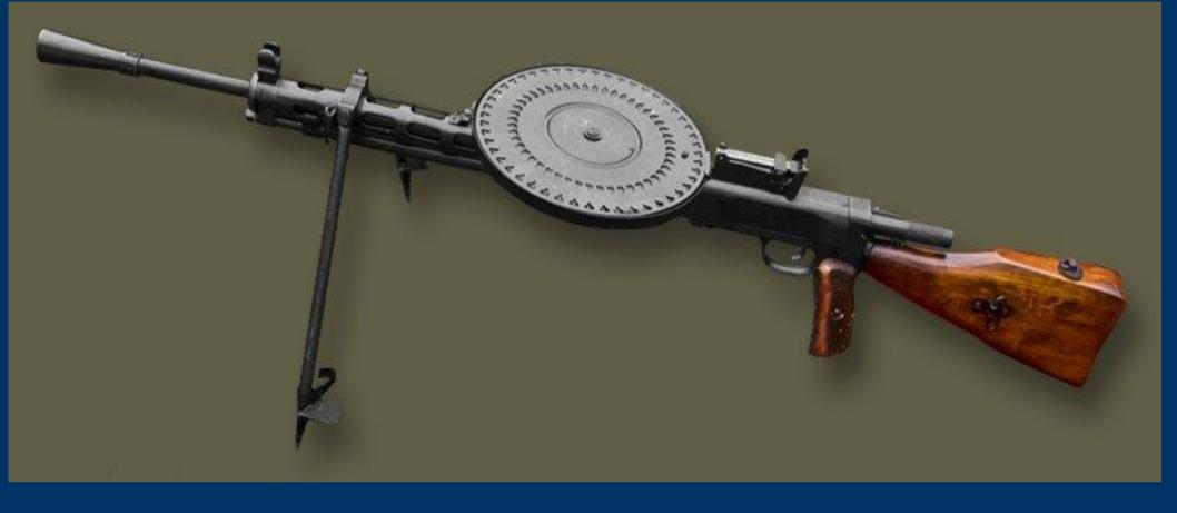
7,62 мм Ручной пехотный пулемет системы Дегтярева модернизированный образца 1945 г. (ДПМ)
