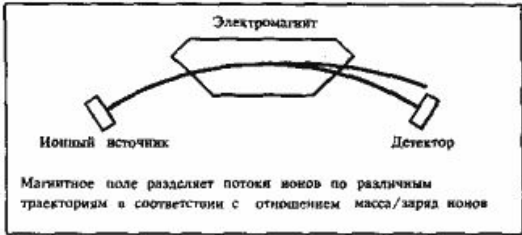
Принципиальная схема масс-спектрометра
