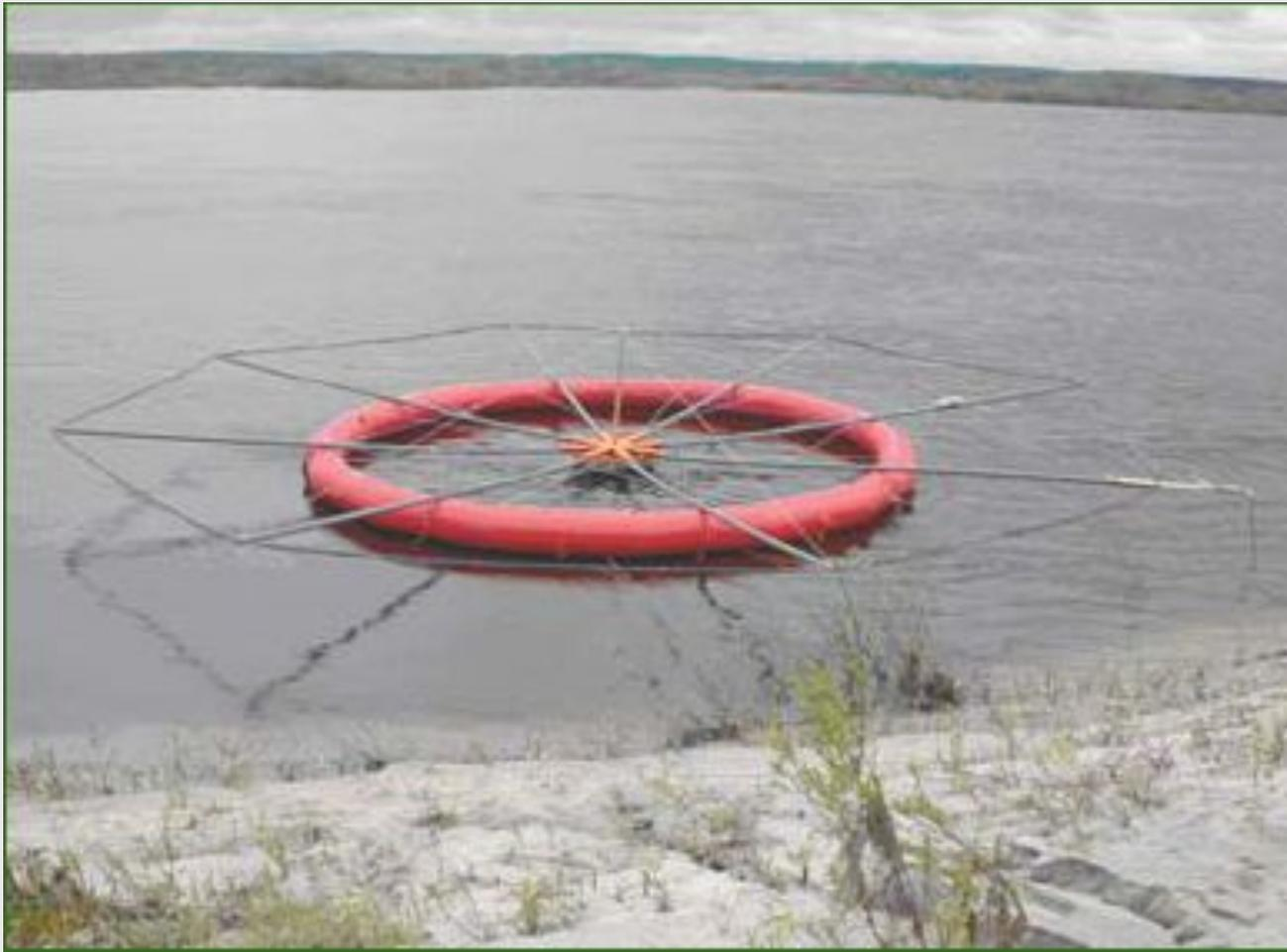
Соосная генераторно-измерительная установка (по Ю.Ю. Дмитриеву). Генераторная антенна, имеет момент  $157 \text{ м}^2$  и обеспечивает глубинность исследований от **25 м до 40 м при толщине слоя воды до 10 м.** Измерительная антенна закреплена в центре генераторной петли.
