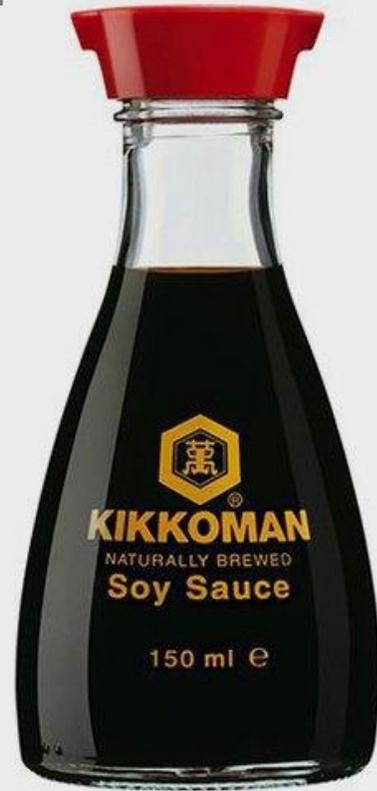
Кэндзи Экуан придумывал бутылку для соевого соуса Kikkoman три года. За это время он перепробовал более 100 прототипов и остановился на 150-миллилитровой колбе с особой крышкой-дозатором, которая устроена подобно носику чайника. Конструкция позволяет налить соус с точностью до капли, при этом жидкость не капает с края и не забивает отверстие, засыхая. Изящная бутылка сделана из добротного стекла. В отличие от большинства пищевых упаковок, ею можно — и хочется! — пользоваться много раз.
