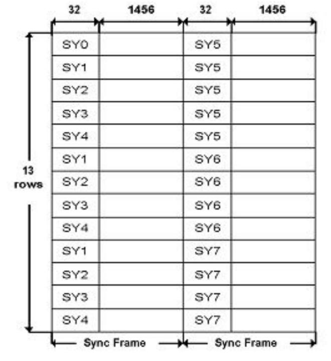
Physical Sector состоит из 13 строк, каждая строка содержит два Sync Frames в составе синхронизирующего кода SYNC Code и 1 456-тибитной последовательности канальных битов (91 байт х 16 бит = 1 456 бит) Запись физического сектора на диск
