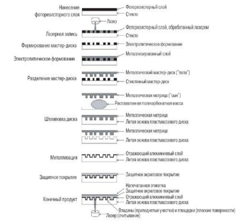
Основные этапы производства компактдисков: 1. Нанесение фоторезисторного слоя. Круглая пластина из полированного стекла диаметром 240 мм и толщиной 6 покрывается слоем фоторезистора толщиной около 150 мкм, после чего обжигается при температуре 80°C (176°F) в течение 30 минут 2. Лазерная запись. Лазерный самописец (Laser Beam Recorder — LBR) посылает им пульсы синего или фиолетового света, которые засвечивают и размягчают определенные участки фоторезисторного слоя стеклянного мастер-диска
