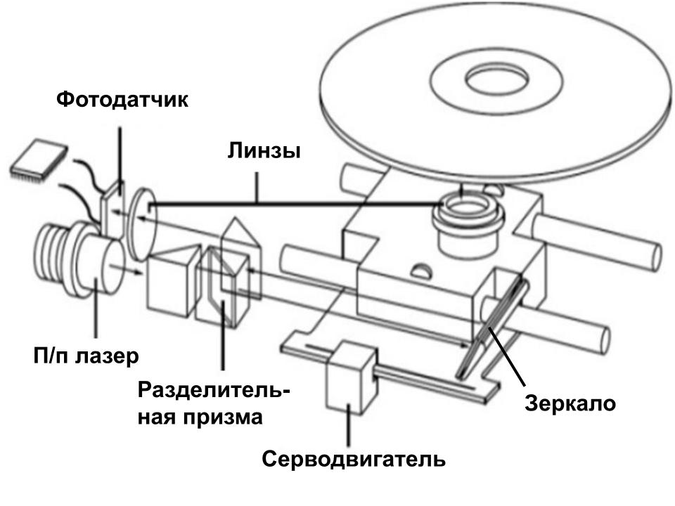
Полупроводниковый лазер генерирует маломощный (1 мВт) инфракрасный луч, который попадает на отражающее зеркало
