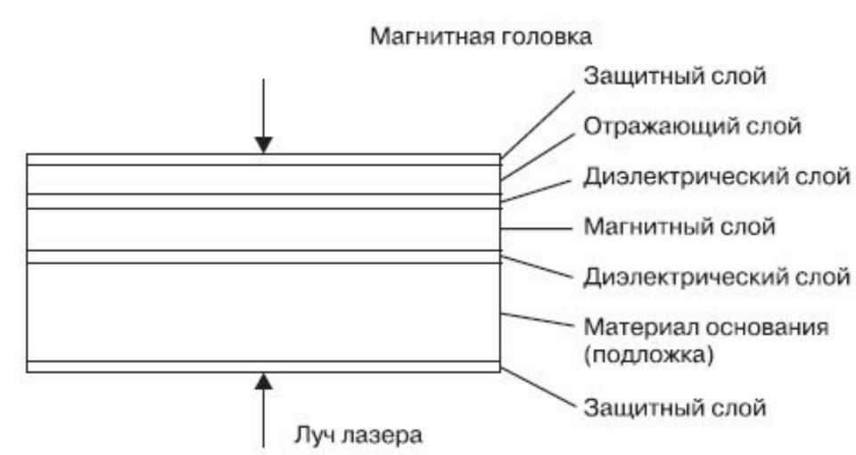
стороны подложки, а магнитная головка находится с противоположной стороны Луч лазера на поверхности диска создает пятно размером около 1 мм Частицы пыли и микроскопические царапины не оказывают при этом существенного влияния на процессы записи и считывания На магнитном слое за счет фокусировки пятно уменьшается уже до микронных размеров, что и определяет размеры намагниченных участков МО-диск помещается в пластиковую коробку со «шторкой» и окошечком защиты от записи
