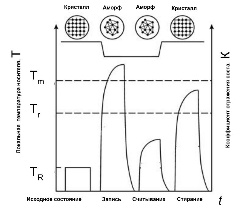
Температура разогретого участка начинает падать с высокой скоростью (более 10<sup>9</sup> К/с в реальных условиях). Высокая скорость охлаждения обусловлена малыми размерами перегретой области
