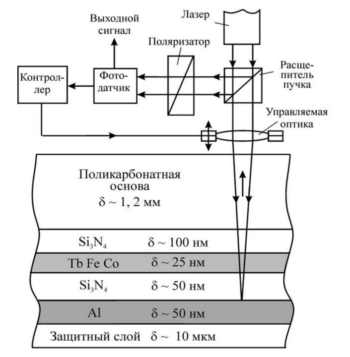
Поляризованный лазерный луч проходит сквозь материал диска, отражается от подложки, проходит сквозь оптическую систему и попадает на фотодатчик
