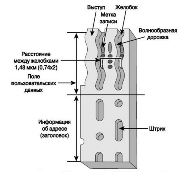
Для записи на диск применяется метод изменения фазы, в соответствии с которым данные записываются на участок, выборочно нагретый с помощью лазера высокой мощности Записывающий лазер накопителя DVD-RAM переводит участок поверхности диска И3 кристаллического в аморфное состояние **3**a счет нагревания поверхности Кристаллическая и аморфная поверхности имеют разные коэффициенты отражения. Сигнал считывается благодаря разнице в отражении лазерного луча от кристаллической и аморфной поверхностей
