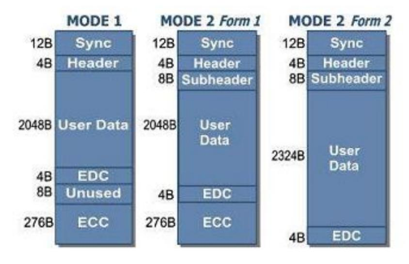
Как видно, режим 1 отличается от режима 2 наличием подзаголовка в последнем, а формы 1 и 2 режима два – размером поля данных
