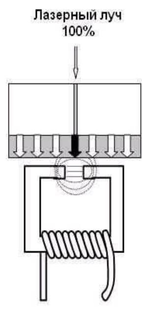
Структура МО напоминает структуру CD-RW, только между диэлектрическими слоями размещается магнитный слой, для которого необходимо обеспечить быстрый отвод тепла
