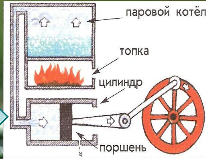
В паровом двигателе пар давит на поршень и вращает колесо.
