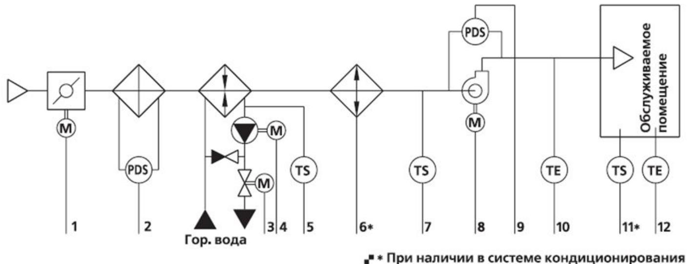
1 - привод воздушной заслонки; 2 – датчик реле перепада давления на фильтре (PDS); 3 - регулирующий клапан; 4 - циркуляционный насос; 5 - термостат угрозы замерзания калорифера по воде (TS); 7 - термостат угрозы замерзания калорифера по воздуху (TS); 8 - вентилятор; 9 – датчик реле перепада давления на вентиляторе (PDS); 10 - датчик температуры приточного воздуха (TE).
