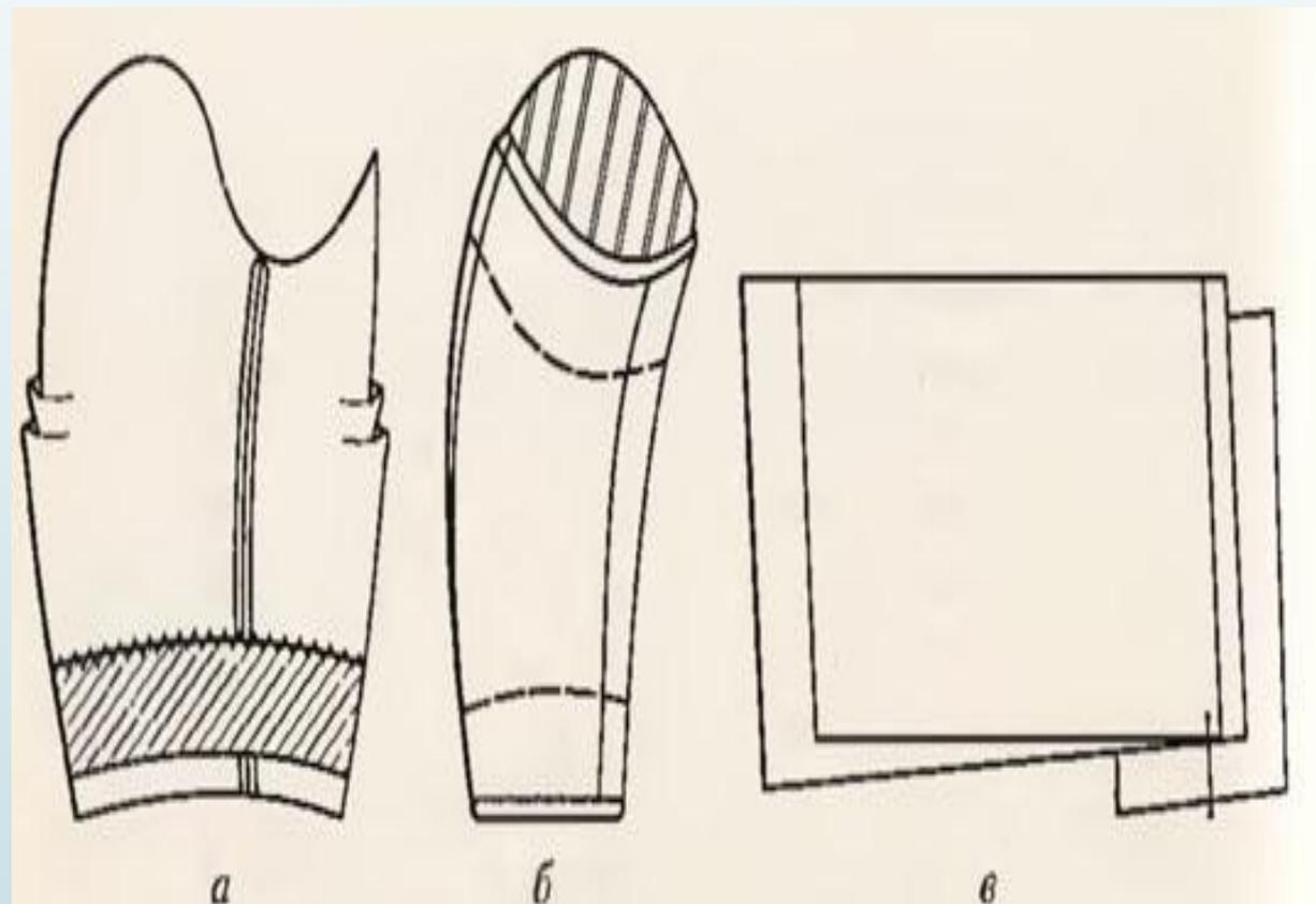
Рис. 1. Обработка двухшовного втачного рукава без шлицы в локтевом шве
