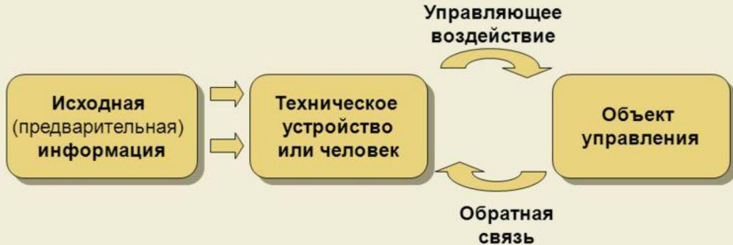
Процесс управления называется **замкнутым**, если в нем учитывается текущая информация об объекте с помощью обратной связи.
