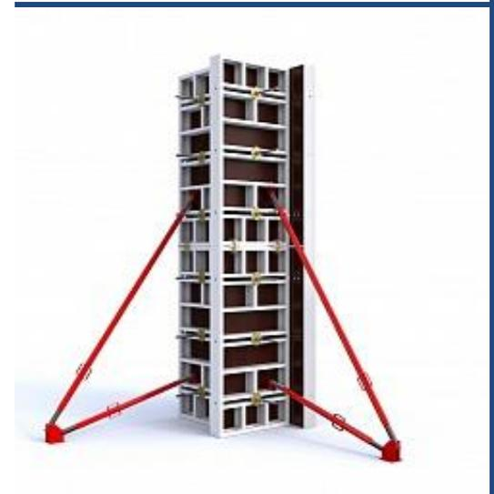
Как и крупнощитовая, **МОНОЛИТНАЯ МЕЛКОЩИТОВАЯ ОПАЛУБКА СТЕН И КОЛОНН** также состоит из обвязочного профиля и профиля перемычек с вмонтированной фанерной палубой (фанера для опалубки толщиной 18 мм).
