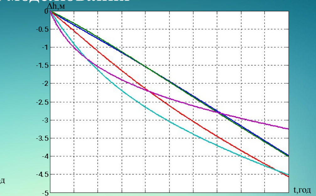
Крива розгону за зміною рівня в I-V корпусах ВУ під впливом зовнішніх збурень зі сторони вторинної пари на +5\%
