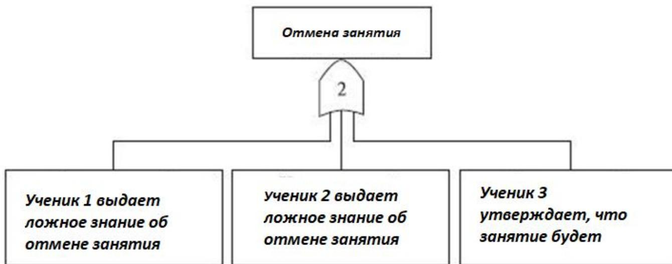
Рисунок 5. Пример использование логического знака «два из трех»
