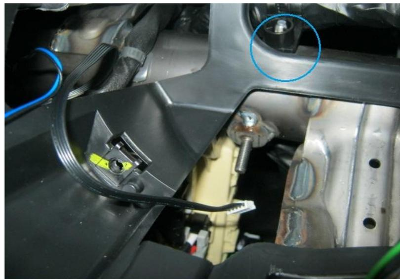
Фото 8. Масса (пластиковое крепление жгута снять)
