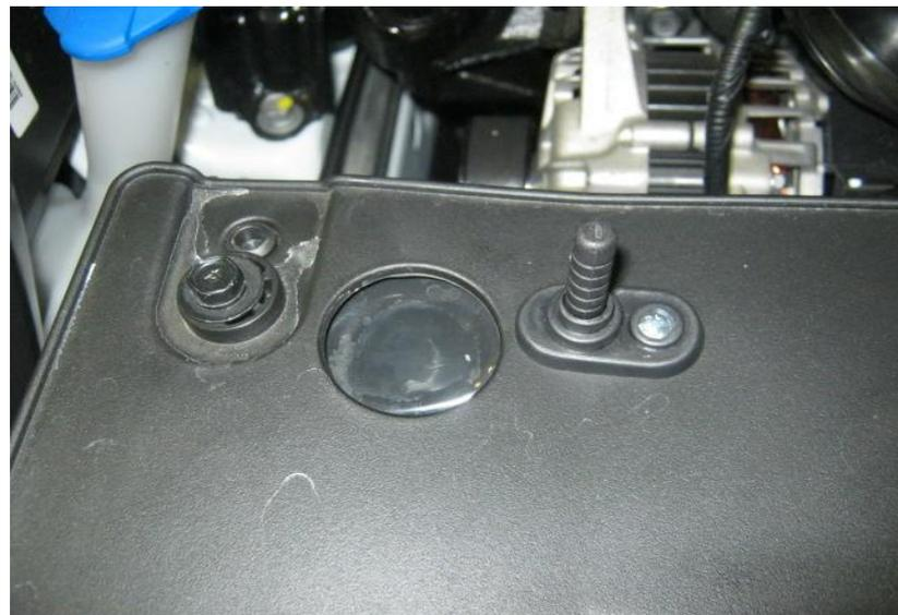
Фото 5.4. Концевик капота.
