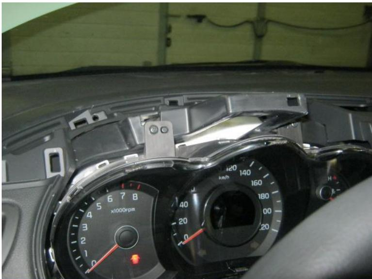
Фото 3.1. Снятие облицовки приборного щитка
