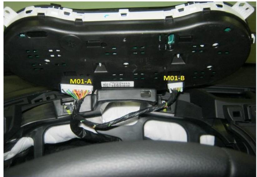
Фото 3.6. Разъёмы приборного щитка
