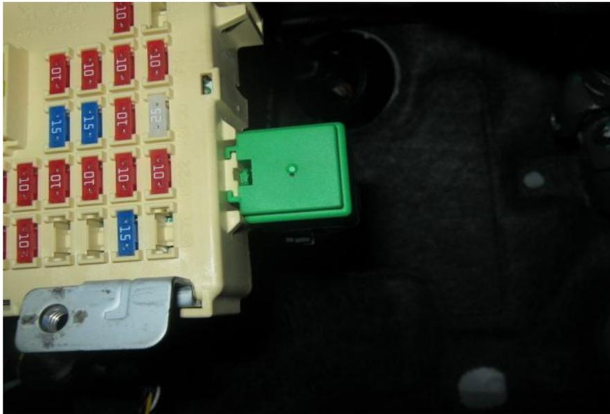
Фото 12.2. Реле стоп-сигнала
