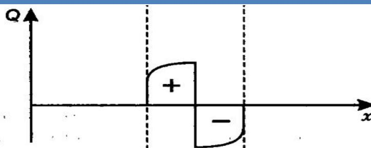
Внутреннее электрическое поле **препятствует** диффузии основных носителей заряда (электронов в n-области и дырок в p-области)
