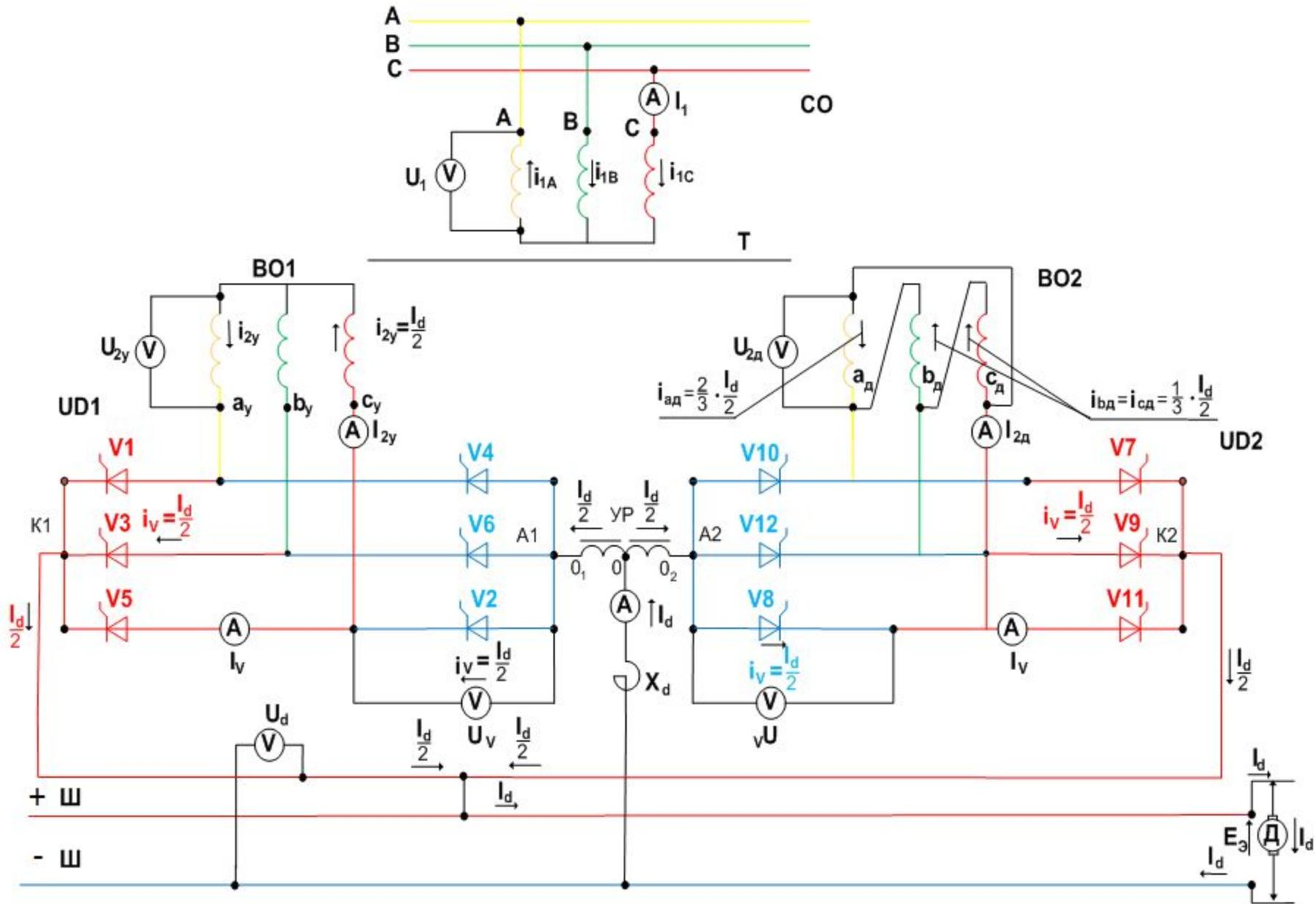
Рисунок 6.8.2 – Схема 12П выпрямителя параллельного типа
