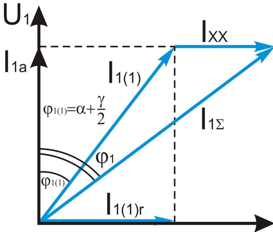
Рисунок 6.8.8 – Векторная диаграмма токов сетевой обмотки выпрямителя
