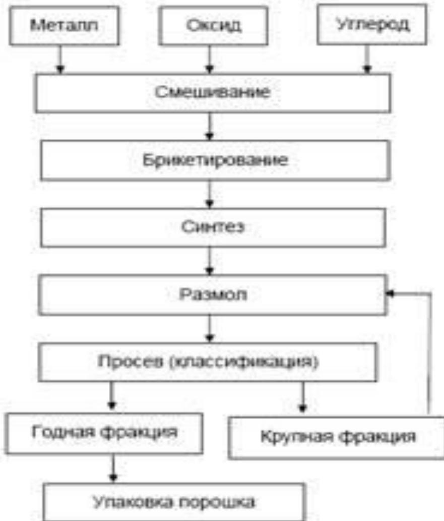
Рис. 2. Технологическая схема производства карбидов синтезом из элементов или восстановлением-карбидизацией
