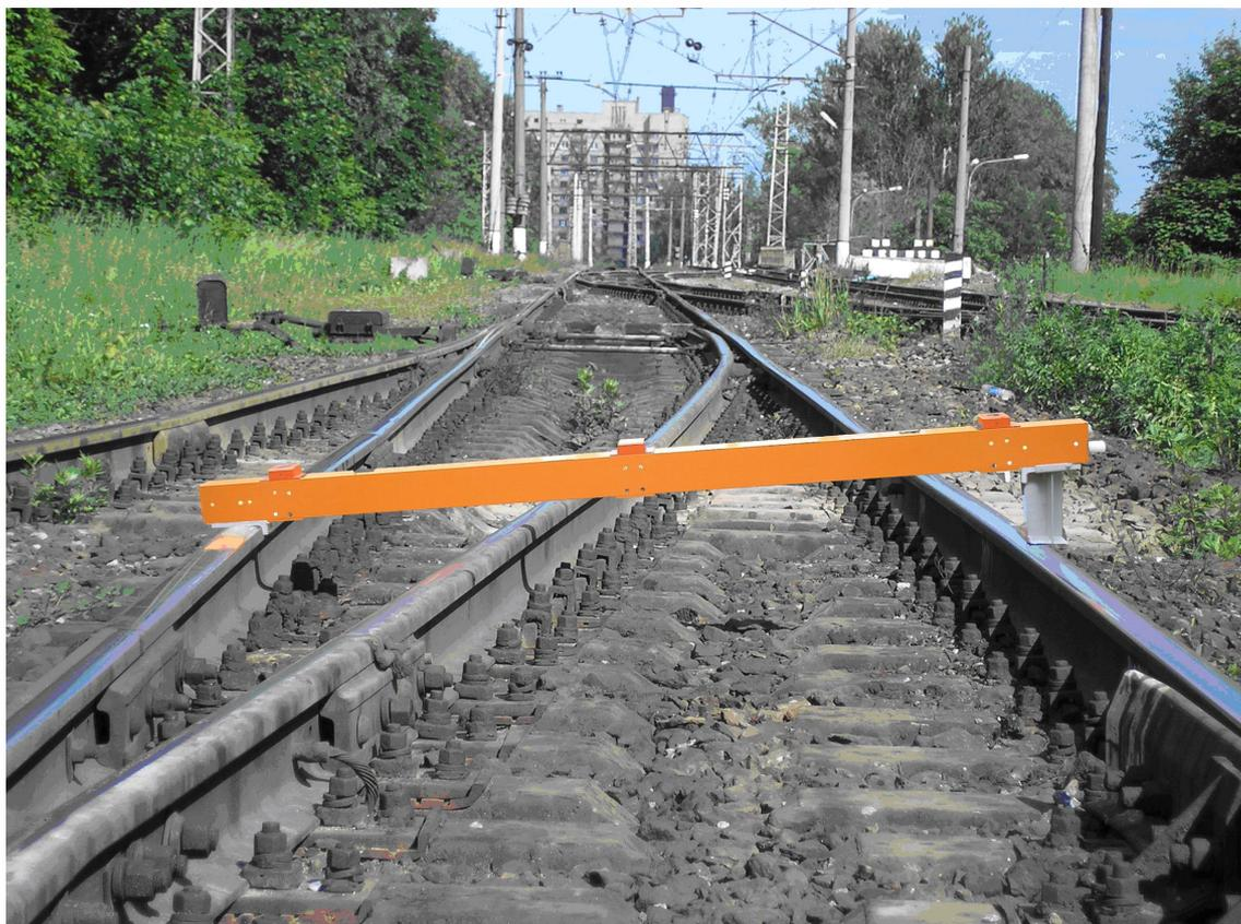
Устройство портативное для измерения параметров контактной сети «ТЕЛЕКС» позволяет выполнить всего четыре измерения, с земли, в течение 10 минут, на месте, получить исчерпывающие данные о параметрах регулировки воздушной стрелки (разница высот контактных проводов на подхвате, смещение проводов от осей путей). С устройством работает бригада из двух человек.
