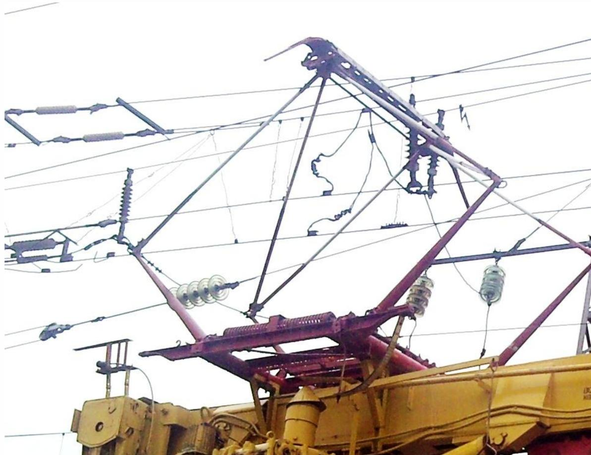
Автоматриса АДМ, Кавказского района контактной сети, после оснащения её изолированным измерительным пантографом даёт возможность проверять качество работы в процессе её выполнения!
