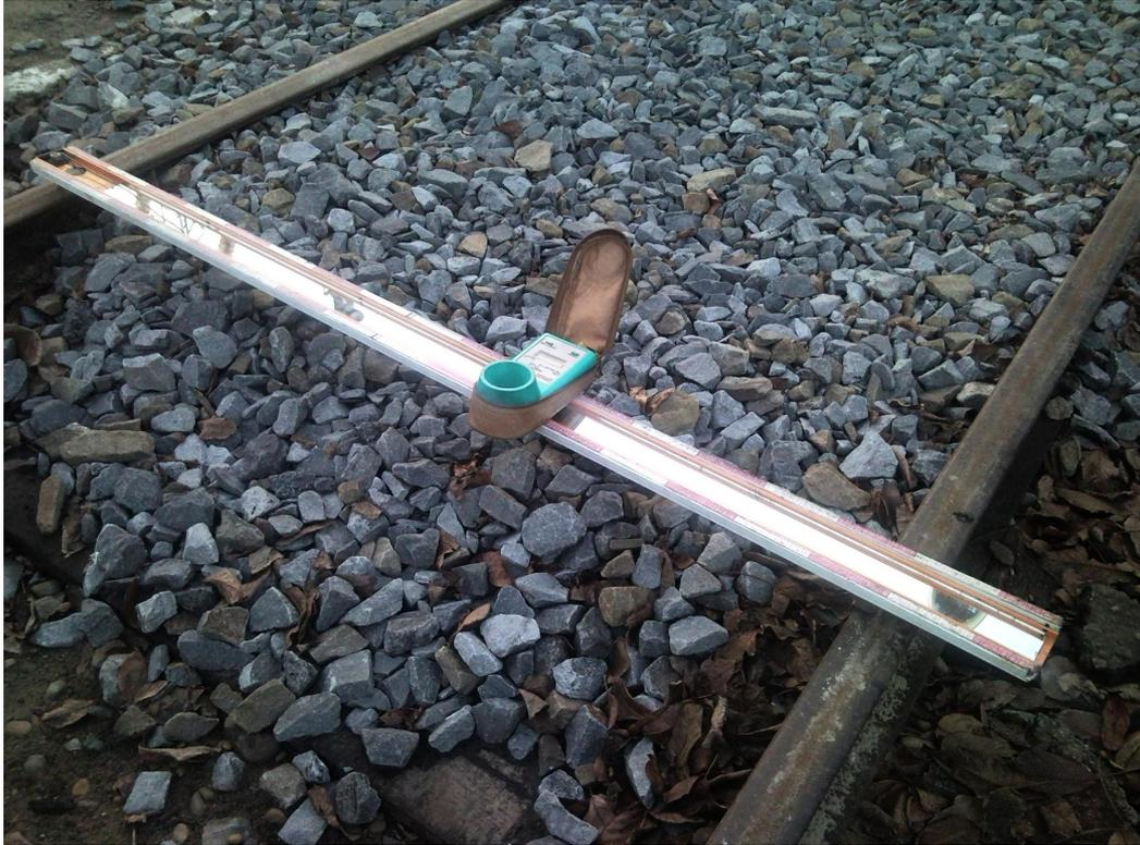
На ЭЧК Кавказская зеркальный шаблон применяется с 1988 года. В настоящий момент эксплуатируется три шаблона различной конструкции. Все электромонтёры умеют правильно использовать и поверять шаблон. Шаблон является обязательным предметом комплектования автомотрисы и автолетучки ЭЧК.
