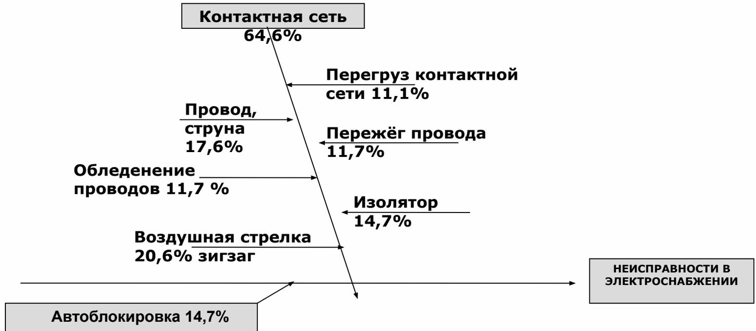
20,6 % отказов в электроснабжении происходит из за нарушения параметров регулировки контактной сети
