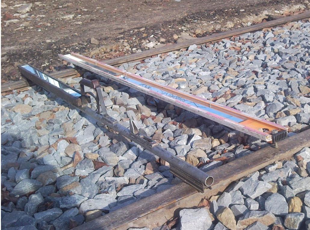
На ЭЧК Кавказская изготовлен и применяется зеркальный шаблон, который позволяет измерять значение смещения проводов относительно оси пути, с земли, с точностью сопоставимой с точностью выдаваемой устройством «Телекс».
