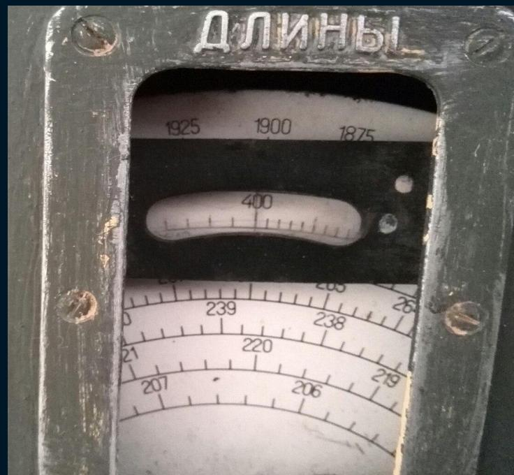
*Установите эталон в пучок света и, **вращая рукоятку** механизма изменения **ширины щели**, установите световой указатель гальванометра на **максимально возможное отклонение от нуля** в пределах шкалы прибора. Запишите показание прибора в таблицу **(Jo)**.*
