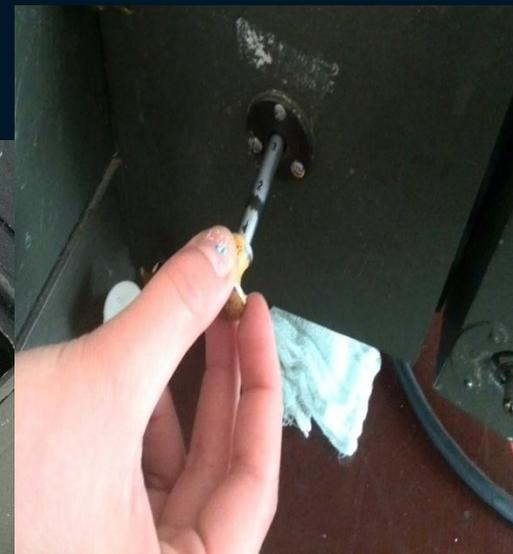
Включите осветитель зеркального гальванометра в сеть и разарретируйте прибор.
