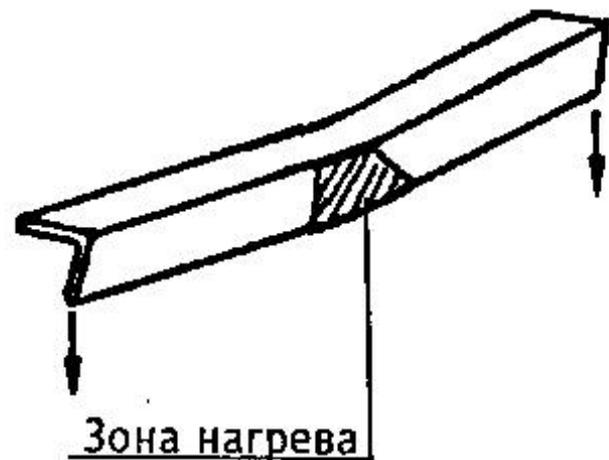
24. Схема газопламенной правки балки коробчатого сечения.
