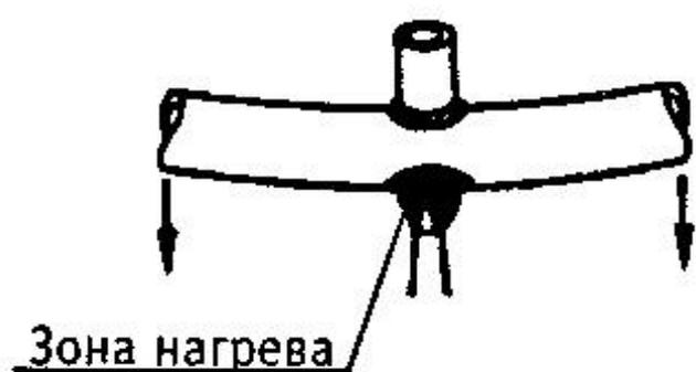
23. Схема правки металлического уголка.
