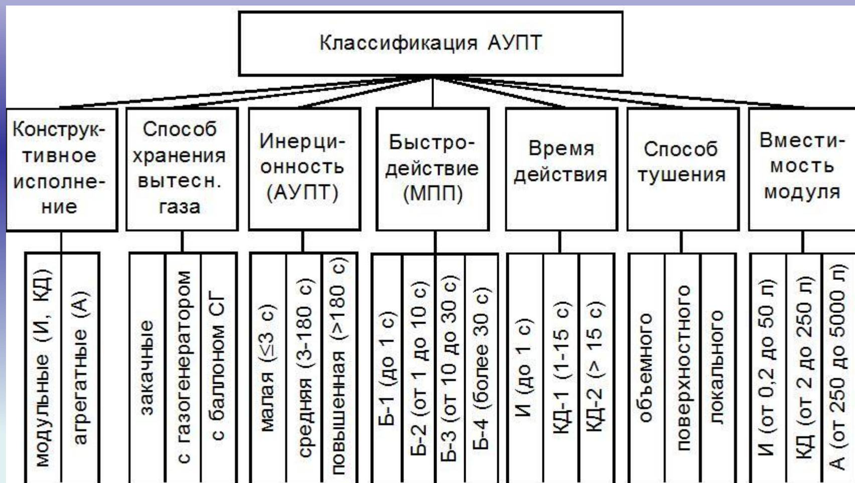
Рис. 2.5. Классификация автоматических установок порошкового пожаротушения по ГОСТ Р 51091-97
