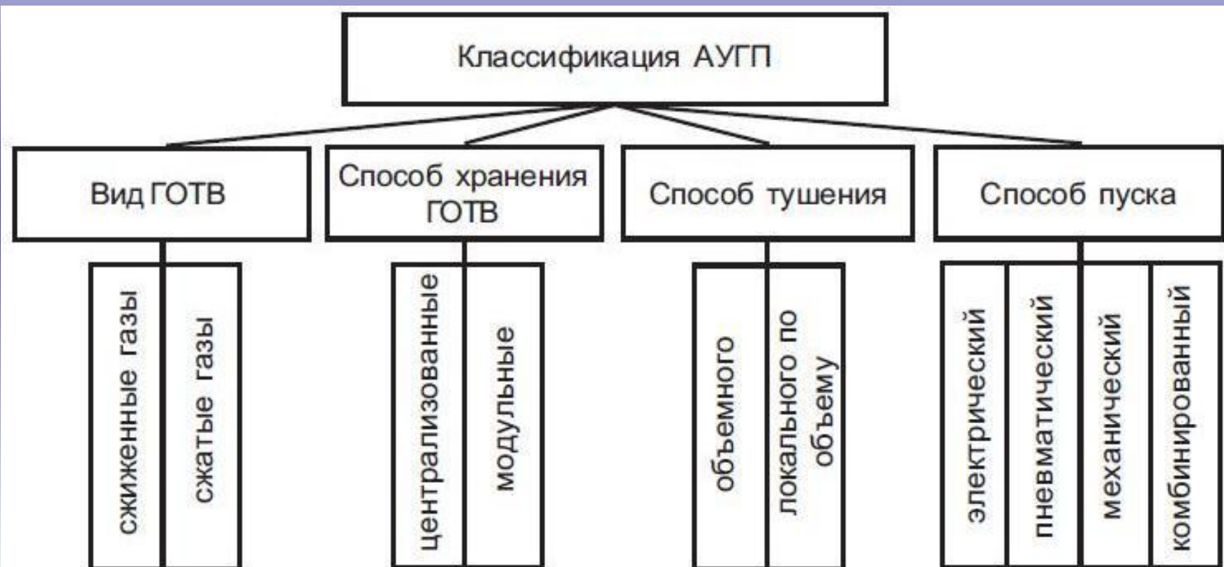
Рис. 2.6. Классификация автоматических установок газового пожаротушения по ГОСТ Р 50969-96, ГОСТ Р 53281-2009, СП 5.13130.2009
