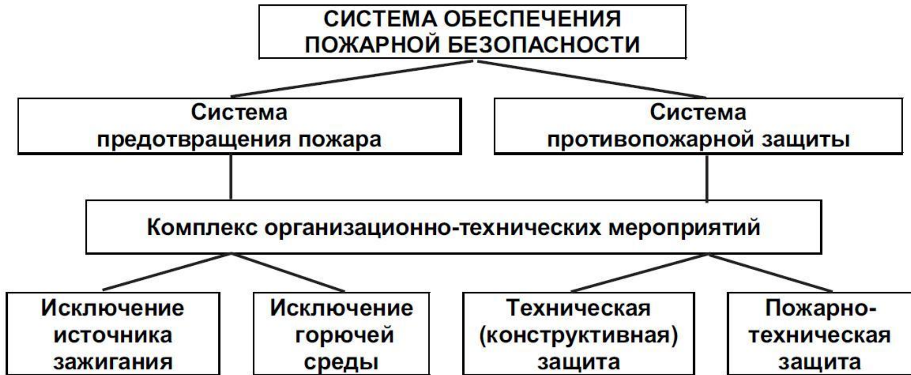
Рис. Система обеспечения пожарной безопасности объекта защиты
