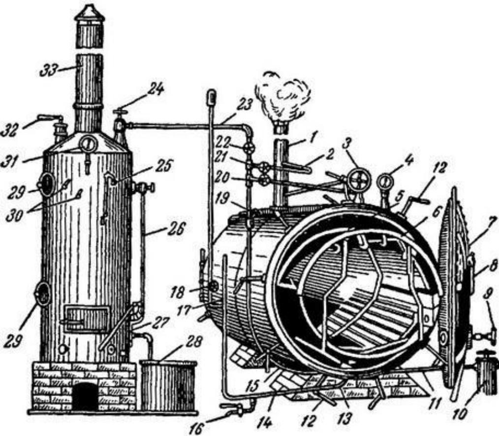
1 — труба вытяжной вентиляции; 2 — труба сифона для усиления вытяжной вентиляции; 3 — маховик управления вытяжной вентиляцией; 4 — манометр; 5 — зонт, предохраняющий вещи от конденсата; 6 — выдвижная тележка; 7 — дверь камеры; 8 — термометр; 9 — клапан приточной вентиляции; 10 — конденсационный сосуд; 11 — магистраль отвода пара от приборов отопления; 12 — зажимы для создания герметичности; 13 — фундамент; 14 — магистраль отвода пара из камеры; 15 — паровая магистраль;
