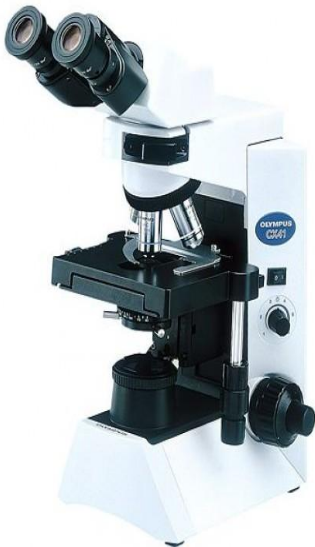
Стереомикроскоп Olympus серии CX41
