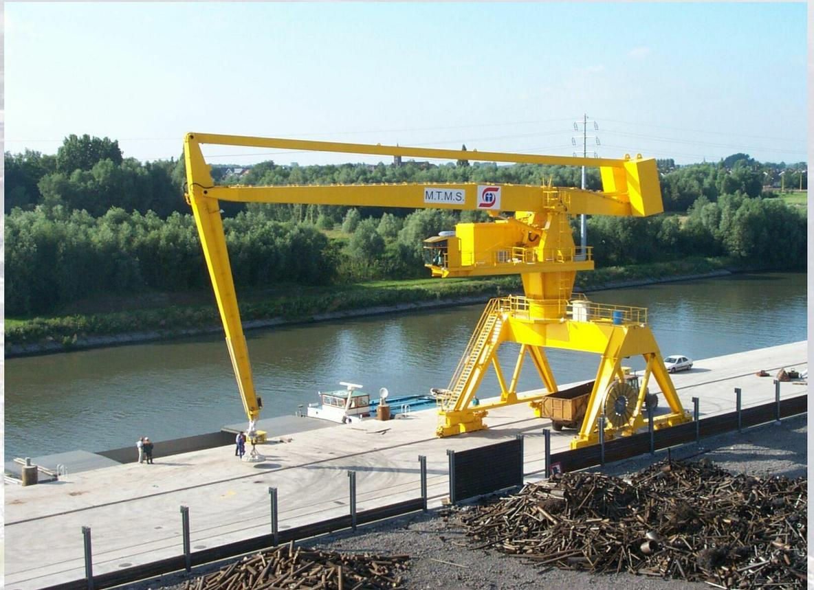
**Нагрузки на причальные сооружения и покрытие территории часто являются основополагающим фактором при выборе кранов**
