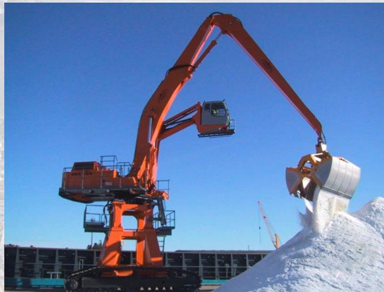
Краны-манипуляторы конструктивно состоят из поворотной части, установленной на шасси (выполненное в виде платформ различной высоты или в виде портала), снабженного колесным или гусеничным механизмом передвижения
