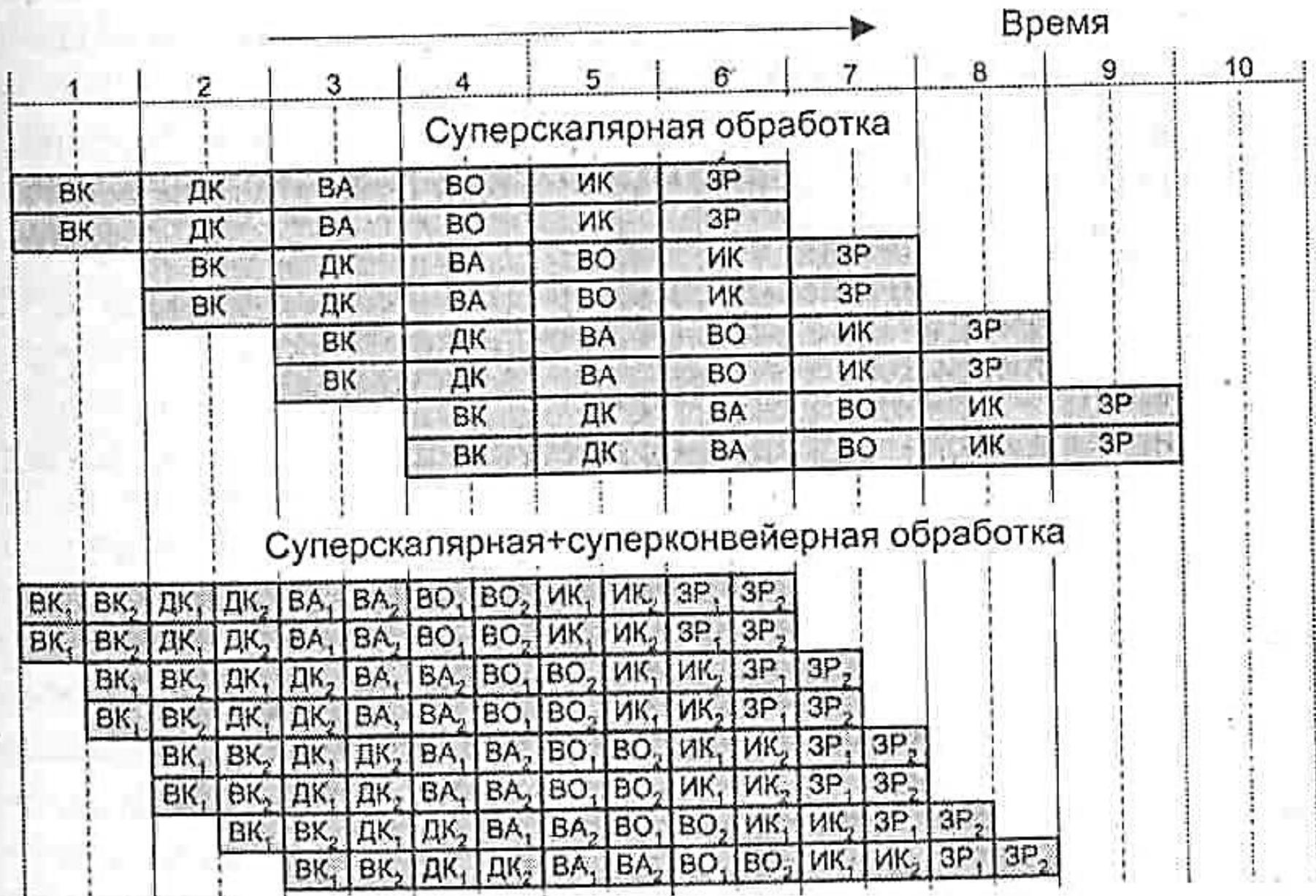
**Рис. 7.12. Сравнение эффективности, стандартной и совмещенной схем суперскалярных вычислений**
