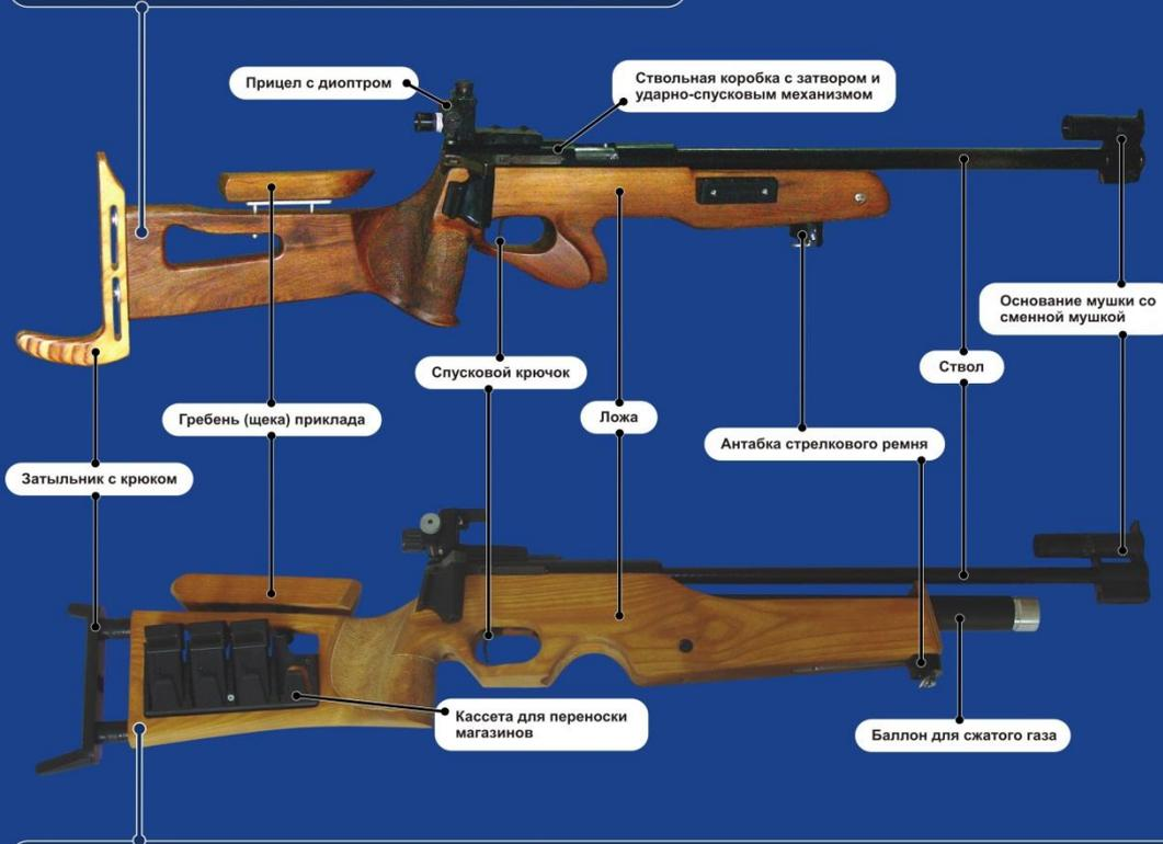
«Биатлон 7-5» — пневматическая винтовка базового исполнения с регулировками длины и высоты приклада
