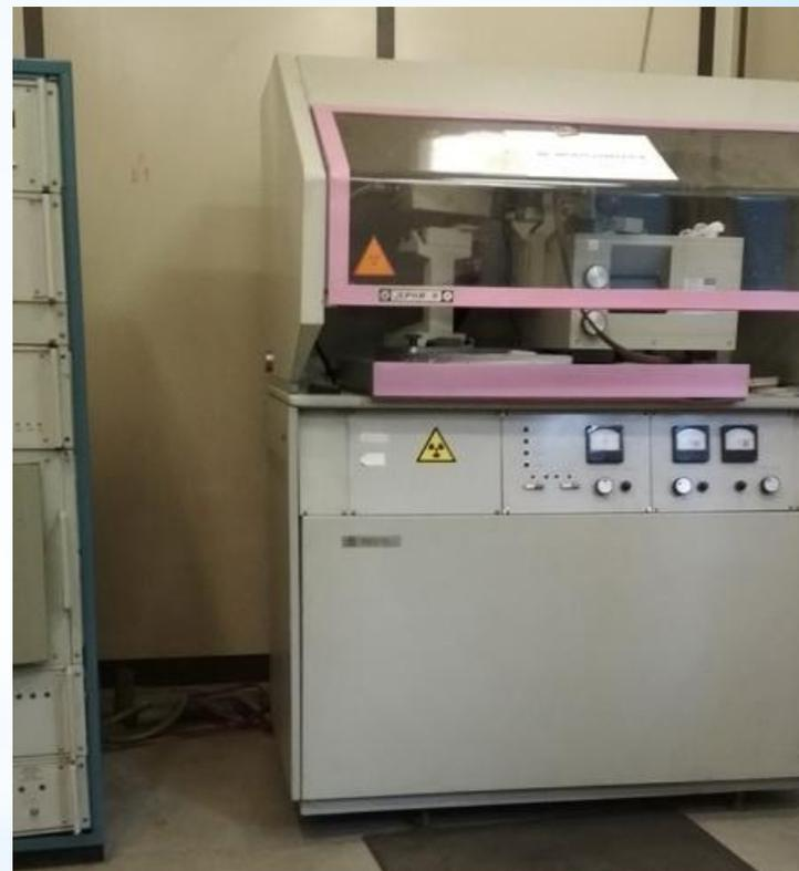
**Оборудование для кристаллографической ориентации монокристаллов, рентгеновская установка CS 26 и ДРОН 3**
