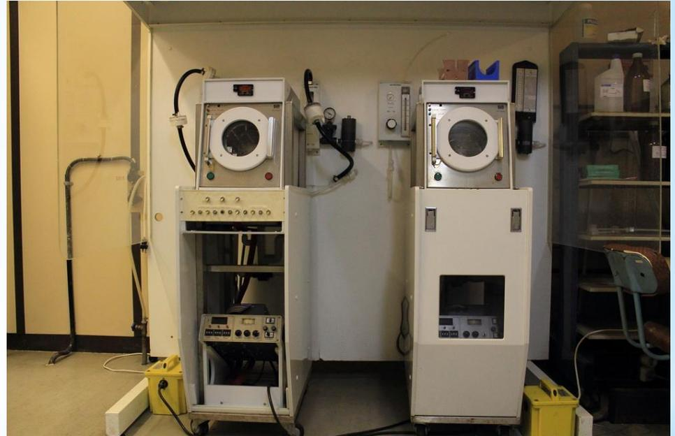
**Установки отмывки пластин, SemiTool, США.**
