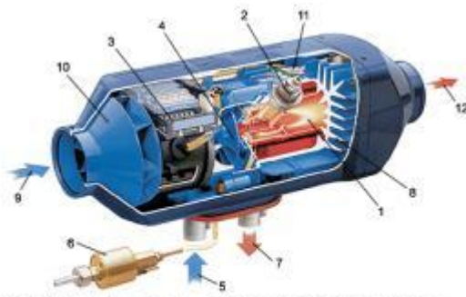
Рис. 5. Воздушный отопитель: 1 — камера сгорания; 2 — свеча накаливания; 3 — электронный блок управления; 4 — крыльчатка вентилятора камеры сгорания; 5 — воздух, всасываемый для камеры сгорания; 6 — топливный дозирующий насос; 7 — выход отработавших газов; 8 — теплообменник; 9 — вход воздуха для нагрева; 10 — крыльчатка вентилятора теплообменника; 11 — датчик перегрева; 12 — выход воздуха, нагретого в теплообменнике.
