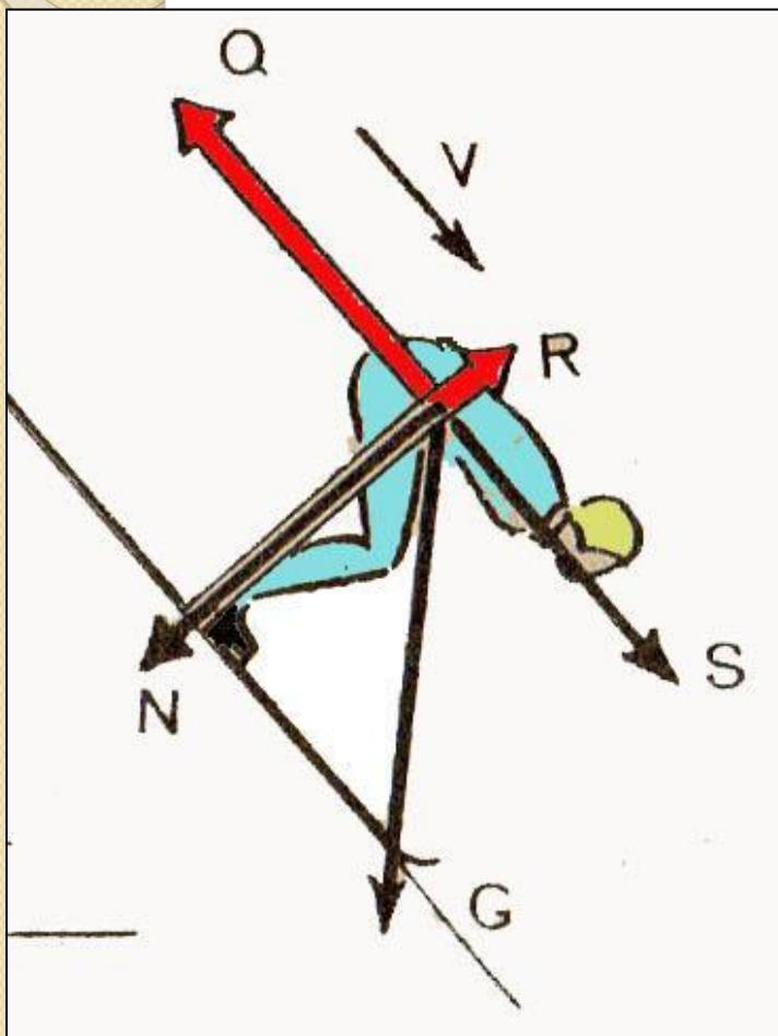
Сопротивление воздуха и трение лыж о снег  $Q$  уравновешиваю при постоянной скорости спуска скатающую составляющую  $S$  силы тяжести лыжника  $G$ .
