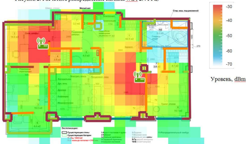
Рисунок 2. Расчётное распределение сигнала WiFi 2.4 ГГц.
