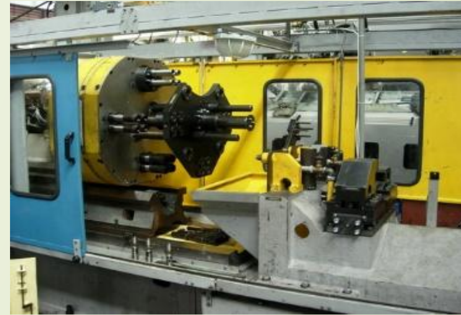
Агрегатный станок AM19236.A6 - сверление - зенкерование - нарезание резьбы
